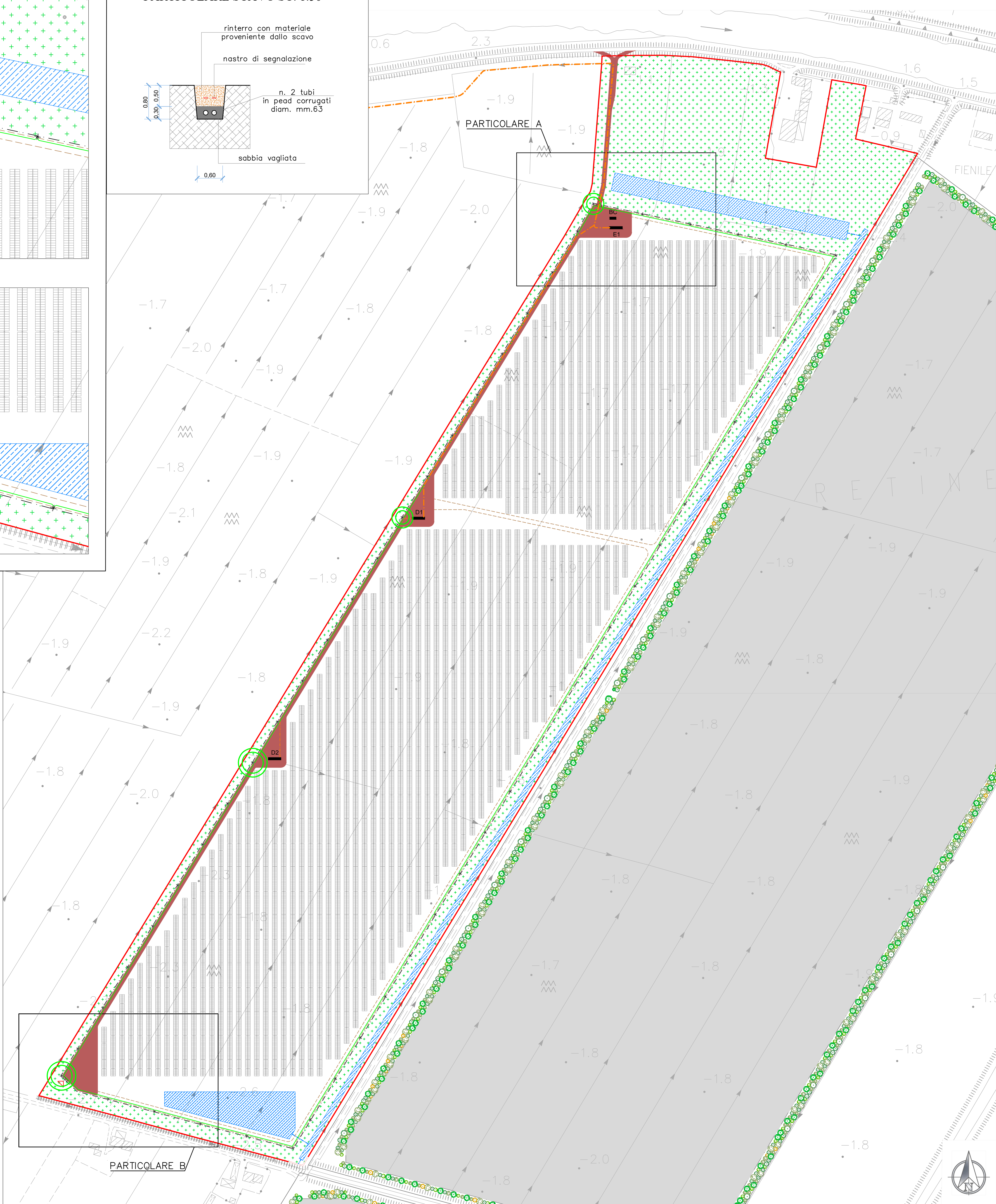
PLANIMETRIA IMPIANTO FOTOVOLTAICO SC. 1:2000
