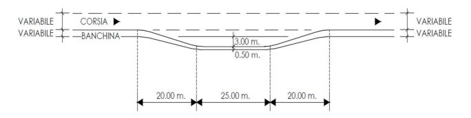
La piazzola prevista nel progetto prevede dimensioni maggiori con un tratto parallelo di lunghezza pari a 50 m (contro i 25 di cui sopra), i tratti di raccordo di lunghezza pari a 20m per uno sviluppo complessivo di 90 m (25 metri in più rispetto a quanto prescritto da normativa). La larghezza dell'area di sosta presenta valore pari a 5,00 m (contro i 3,00 m di cui sopra), per maggiori dettagli si rimanda al dossier dedicato ai tipologici
