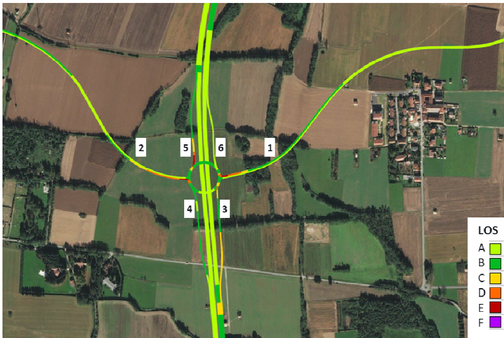
Figura 2.7: LOS – Svincolo di Bellusco
