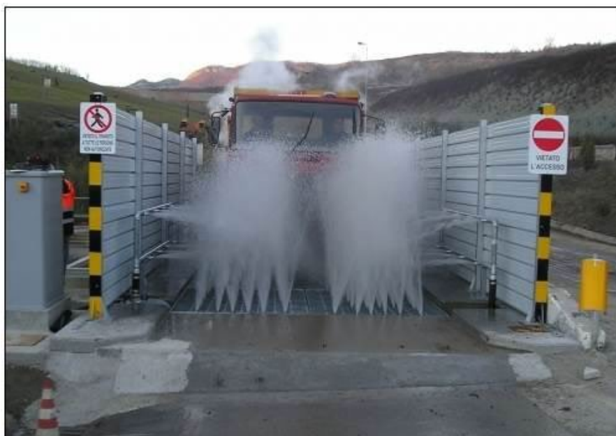
Figura 8.1: esempio impianto lavaggio ruote automezzi
