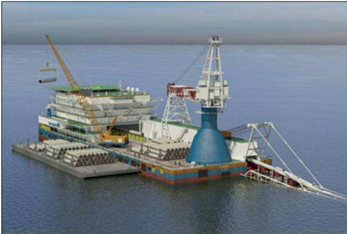
**Figura 13.6: Esempio di Nave Posatubi in Azione**
