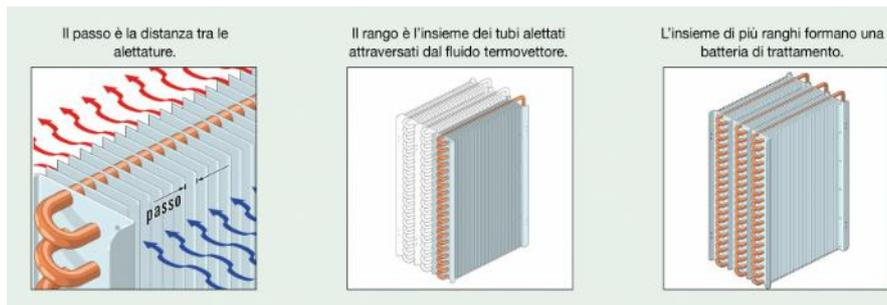
*Figura 12 Batteria di trattamento dell'aria*
