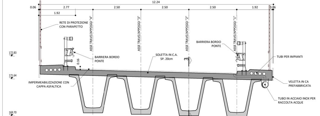
**SEZIONE "2-2" \_TRASVERSALE IN ASSE APPOGGIO SPALLA "A"**
