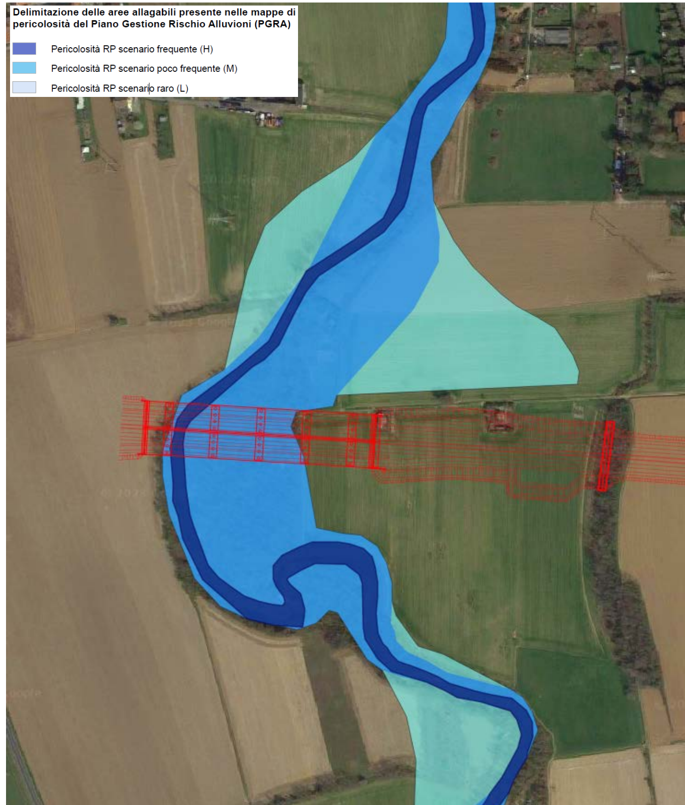
Figura 3.35. Estratto della cartografia della pericolosità alluvionale del PGRA (revisione 2022) nell'ambito di attraversamento del T. Molgora tra Carnate e Vimercate (fonte: Geoportale Lombardia).
