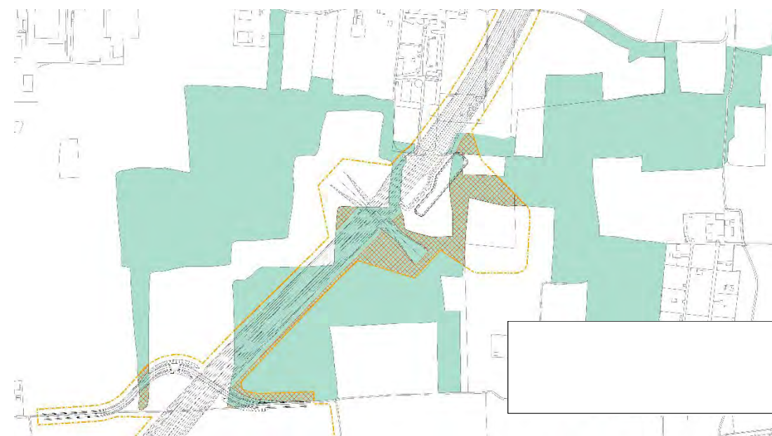
Figura 4.7 Esempio di superfici forestali interferite dal cantiere
