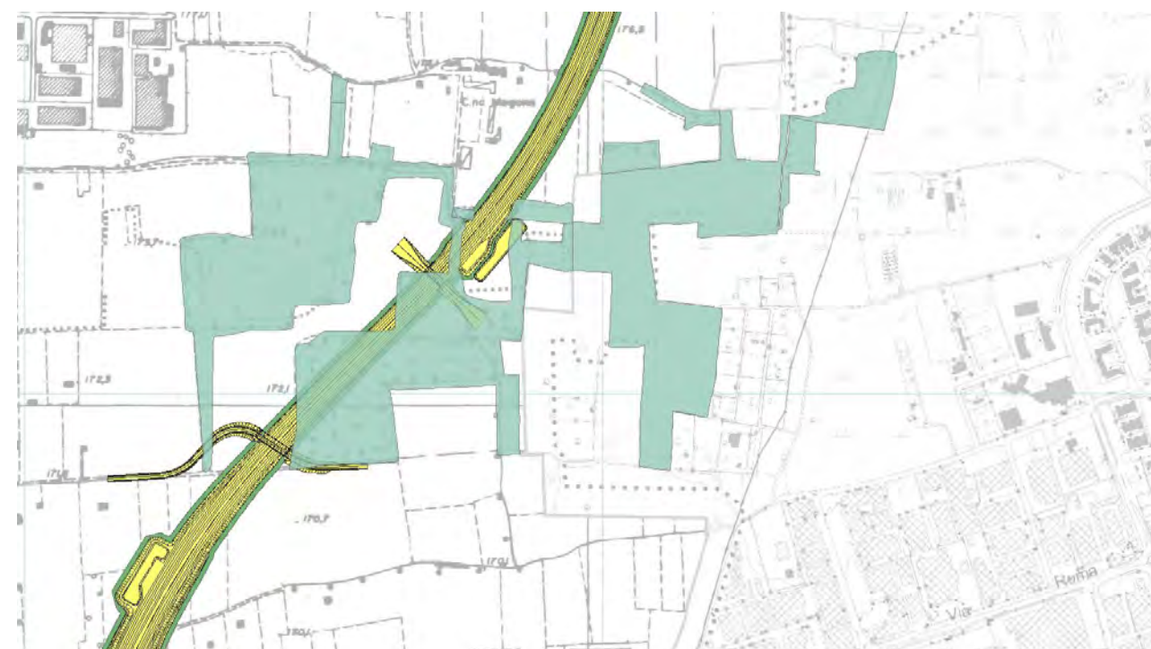
Figura 4.5 Interferenze con le aree boschive presso Burago M. e Agrate
