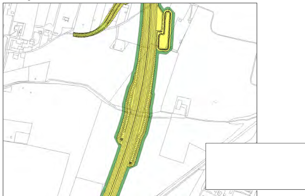
Figura 4.1 Determinazione dell'ingombro stradale e dell'area di pertinenza di 8 m, ai fini del calcolo della trasformazione permanente di superficie boscata
