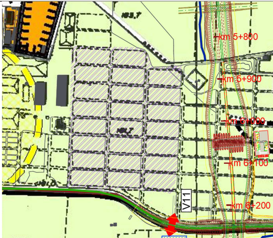
Figura 135. Area stoccaggio indicata all'altezza della progressiva km 6+000. Sovrapposizione tracciato in progetto (da km 5+800 sino a circa km 6+300) e Tavola DdP4.0 "Inquadramento urbanistico territoriale - Piani comunali" dei Documenti di piano del PGT del comune di Ornago. Le aree con riempimento a quadretti blu e la sigla BFX indicano i bacini di filtrazione connessi alle vasche di laminazione (compresi nei siti di produzione) in rigato viola l'area di stoccaggio).
