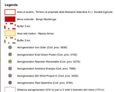
Distanza aerogeneratori (510 m) pari a 3 volte il diametro del rotore (170 m)
