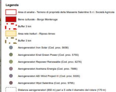
Distanza aerogeneratori (850 m) pari a 5 volte il diametro del rotore (170 m)
