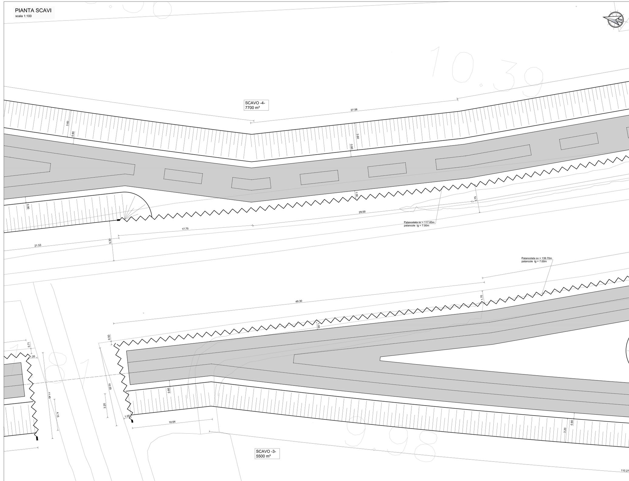
NOTA: Per l'esecuzione del Jet Grouting è necessario realizzare delle perforazioni a vuoto per 2.50m medi
