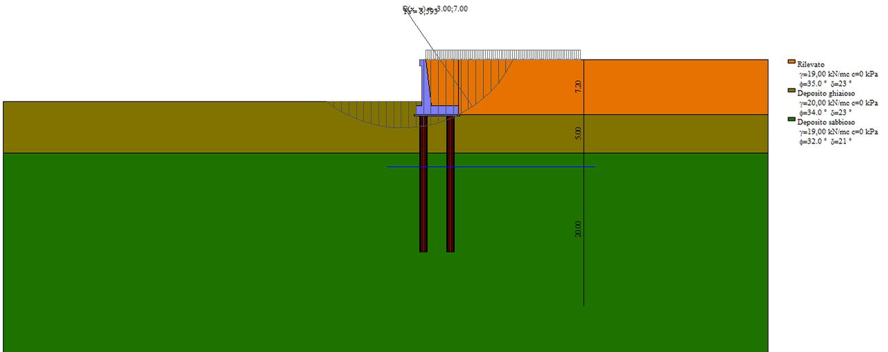
Figura 8-24. Analisi stabilità – Combinazione più sfavorevole (Comb. 5) – FS=3.59
