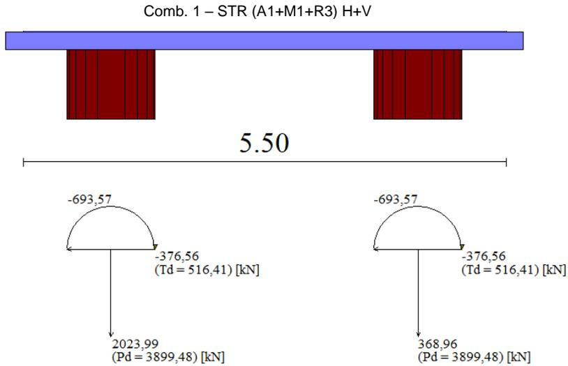
Figura 8-6: Scarichi in testa ai pali di fondazione del muro per la combinazione piu sfavorevole (Comb.1)
