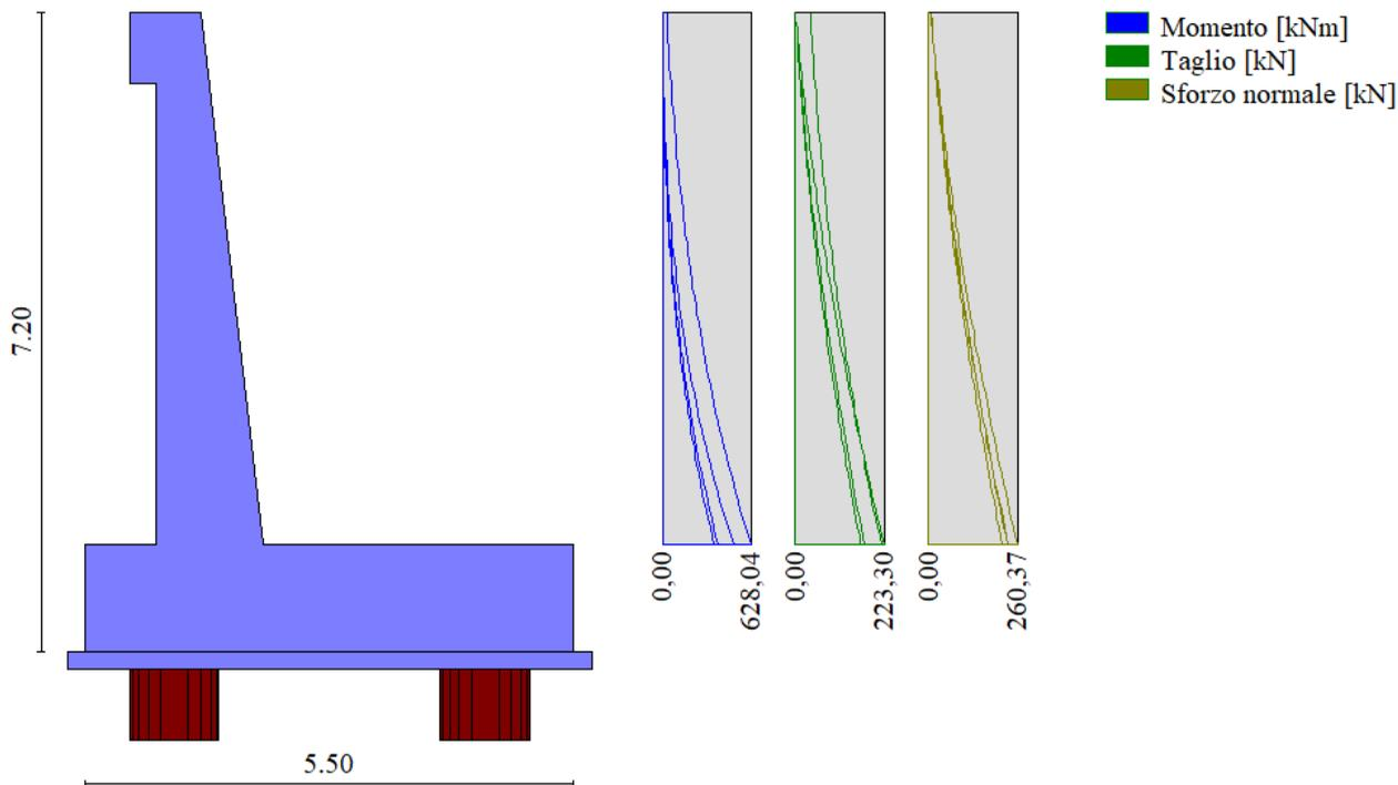
Figura 8-1: Involuppo delle sollecitazioni del paramento del muro
