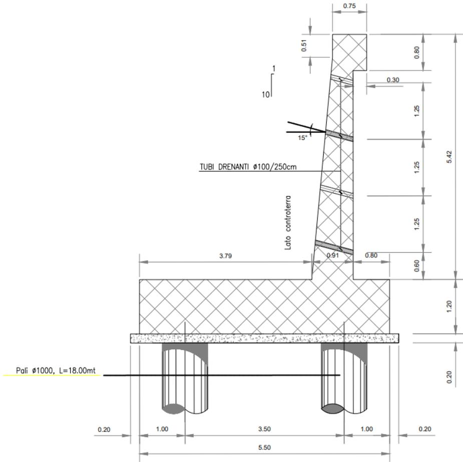
Figura 5-1: Sezione tipologica muro di sostegno su pali "Tipo 1".
