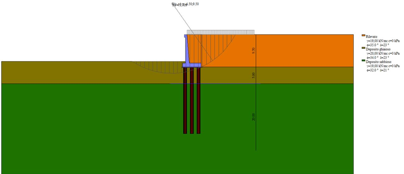
Figura 8-25. Analisi stabilità – Combinazione piu sfavorevole (Comb. 5) – FS=3.41
