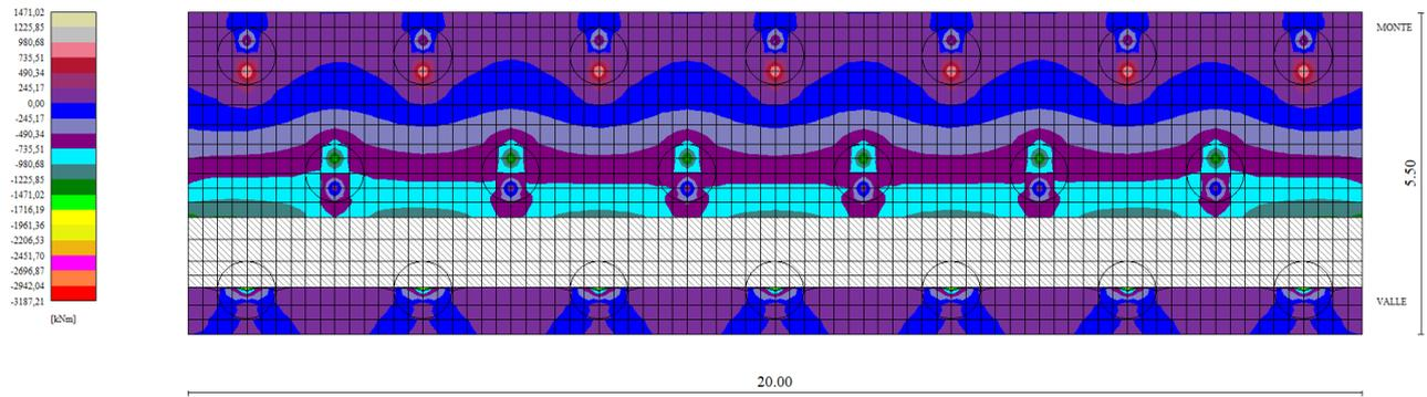
Figura 8-10: Myy sulla fondazione del muro – Comb. 2 – Myy,max = 1320 kN
