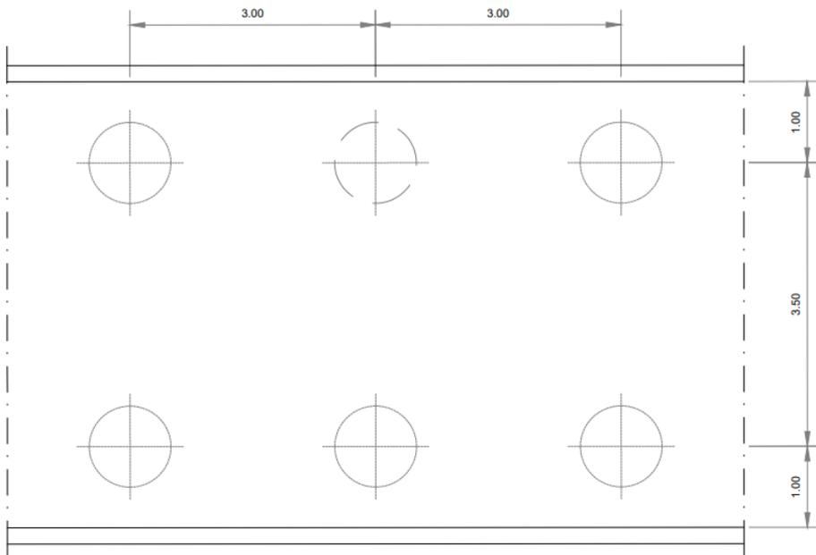
Figura 5-2: Pianta muro di sostegno su pali "Tipo 1".
