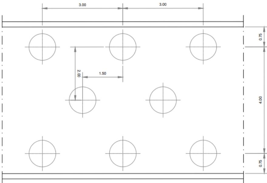
Figura 5-4: Pianta muro di sostegno su pali "Tipo 2".
