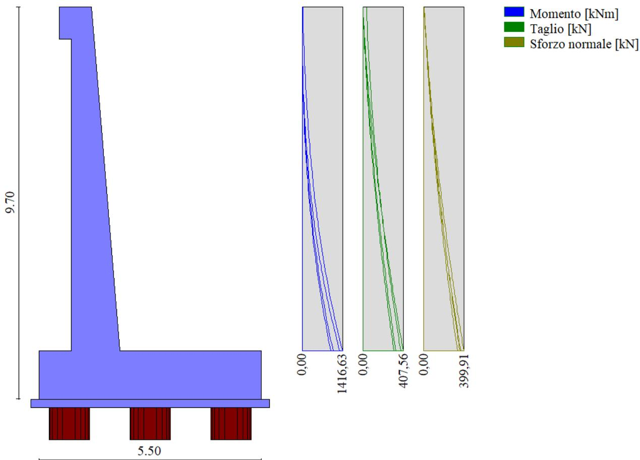
Figura 8-8: Involuppo delle sollecitazioni del paramento del muro
