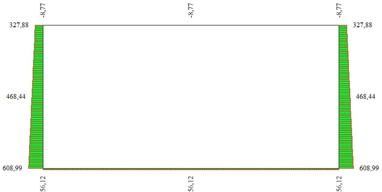
Figura 9.3 Diagramma Sforzo normale G1+G2
