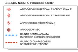
N.B. In corrispondenza delle spalle e del giunto intermedio deve essere garantito un varco (in direzione longitudinale) di ampiezza 50mm.
