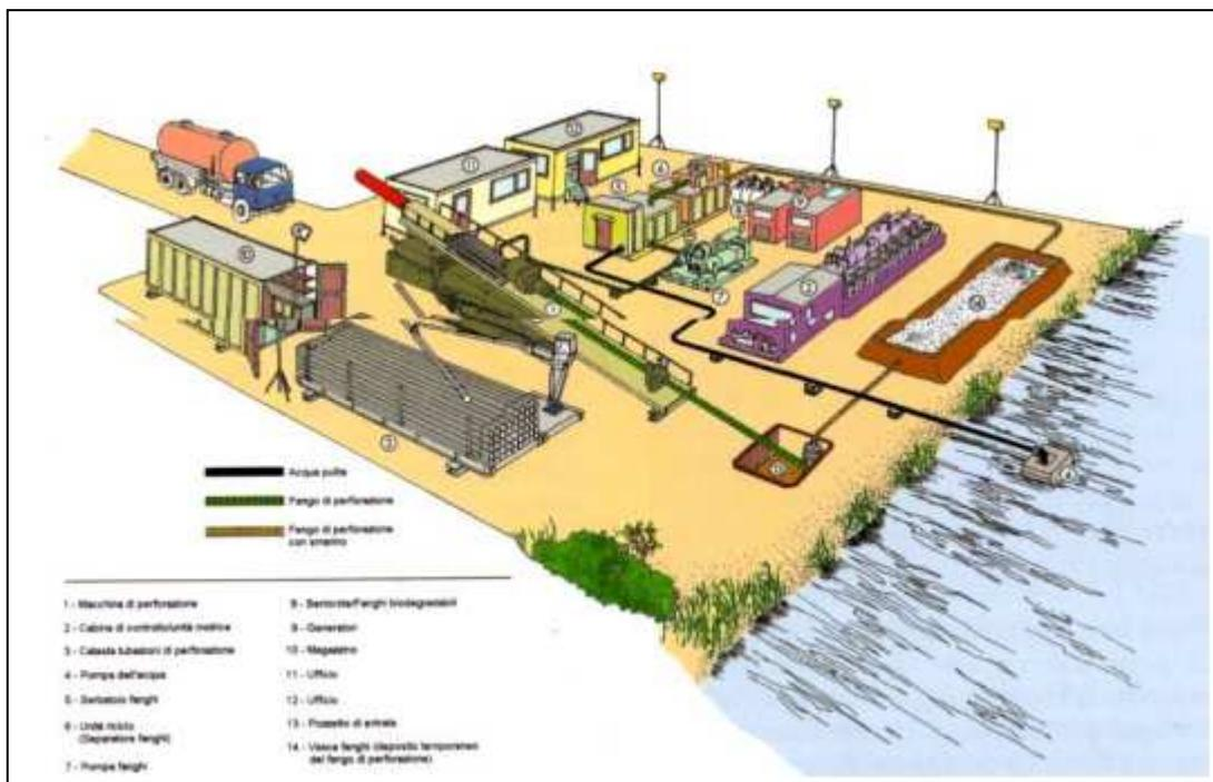
**Figura 3-2: Layout Standard dell'Area di Perforazione**
