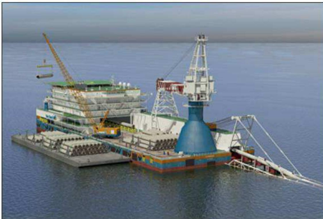
**Figura 4-4: Esempio di Nave Posatubi in Azione**
