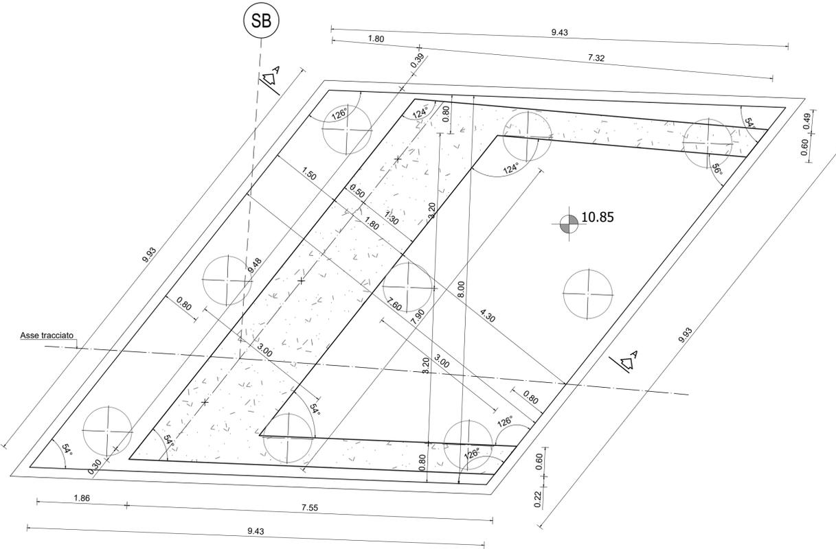
PIANTA APPOGGI SPALLA "B" - LATO RAMO BIDIREZIONALE 1
