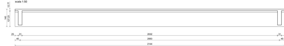
SEZIONE TRASVERSALE CORRENTE PONTE
