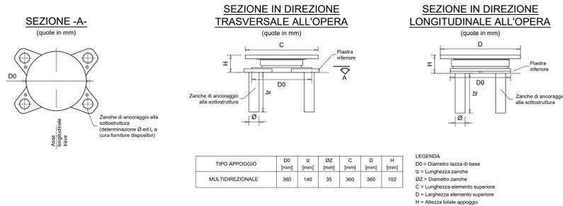
**DISPOSITIVI DI APPOGGIO A DISCO ELASTOMERICO CONFINATO - UNIDIREZIONALE LONGITUDINALE**
