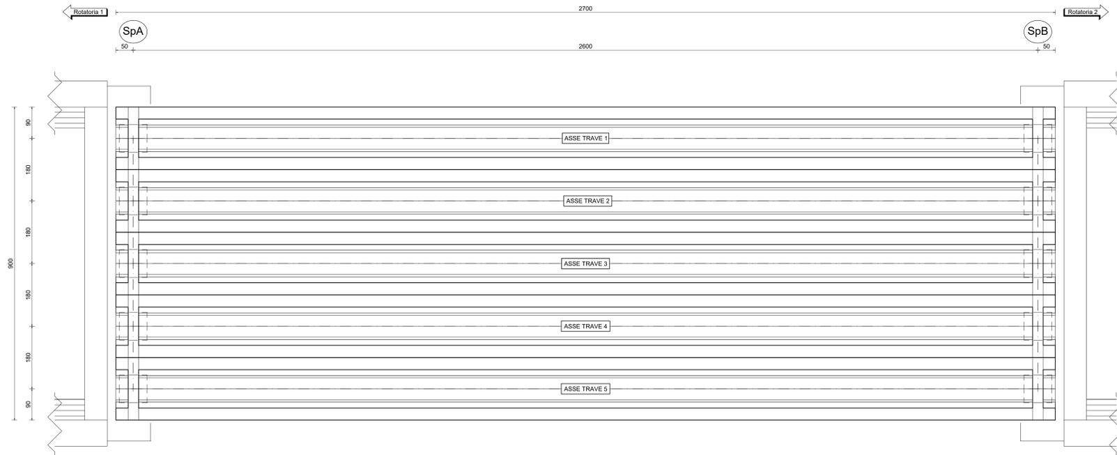
SEZIONE TRASVERSALE CORRENTE PONTE
