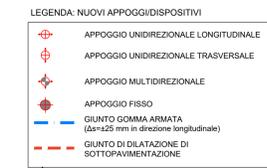
N.B. In corrispondenza delle spalle e del giunto intermedio deve essere garantito un varco (in direzione longitudinale) di ampiezza 50mm.
