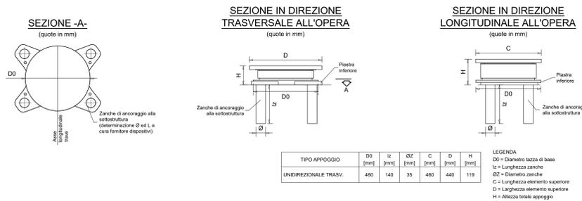
DISPOSITIVI DI APPOGGIO A DISCO ELASTOMERICO CONFINATO - UNIDIREZIONALE LONGITUDINALE
