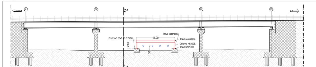
Sezione A-A cassero metallico di protezione del fascio tubiero in corrispondenza del ponte PT.01
