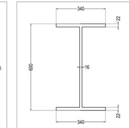
Sezione A-A cassero metallico di protezione del fascio tubiero in corrispondenza dell'opera GA.01
