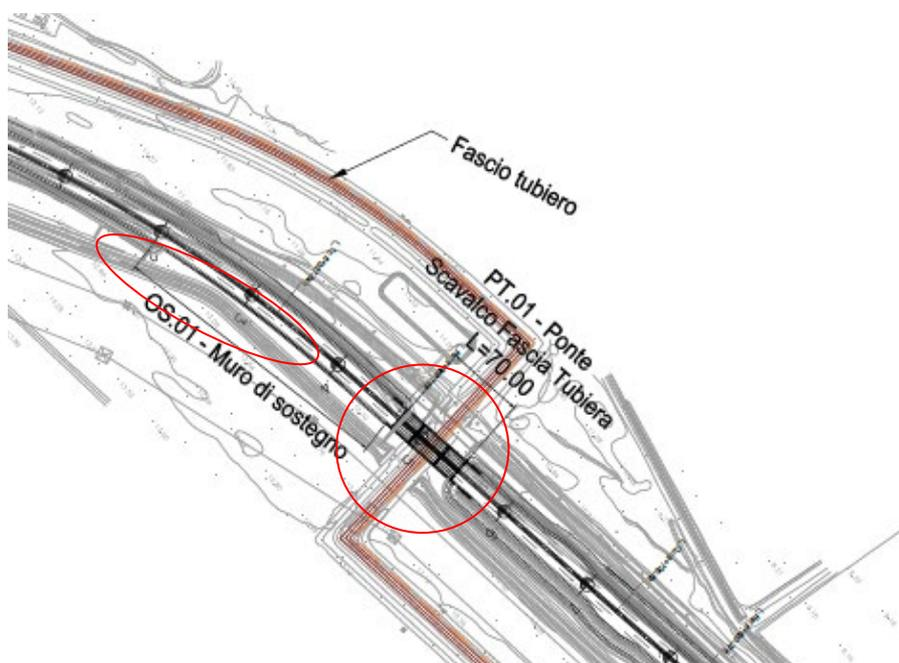
Figura 2: ponte scavalco Fascia Tubiera a tre campate, Progetto Definitivo in corso
