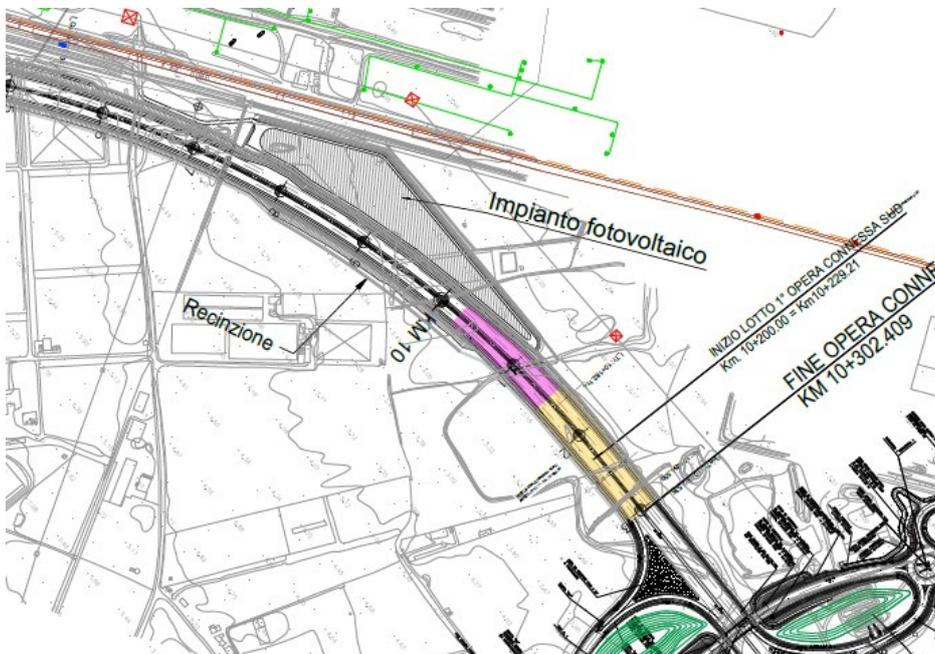
Figura 11: Progetto Definitivo in corso, in evidenza l'ultimo tratto del tracciato di progetto sottoposto a consolidamento, in rosa la precarica, in giallo il jet grouting.
