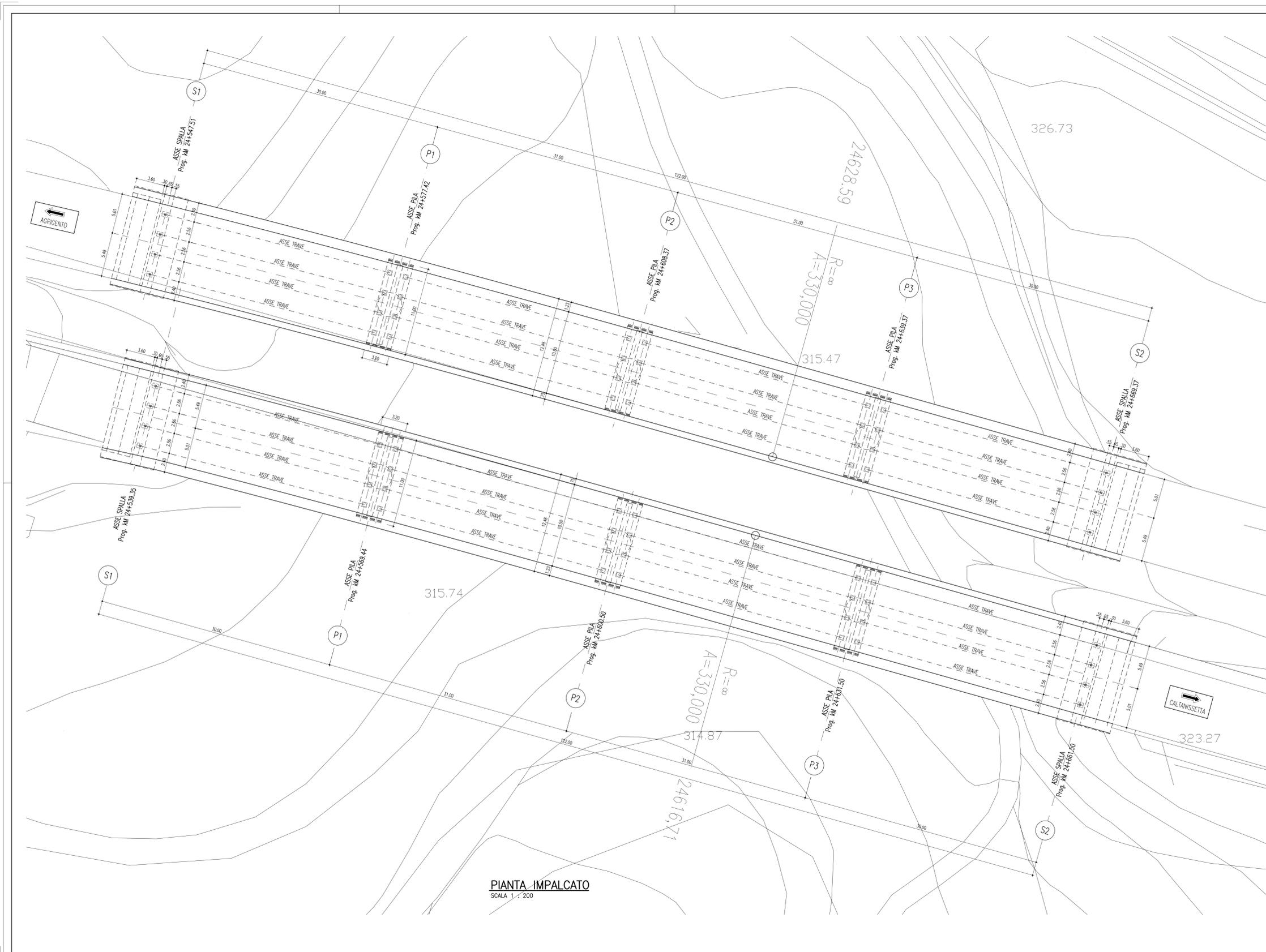
N.B. : GLI INTERASSI PILE SONO MISURATI SULL'ASSE IMPALCATO
