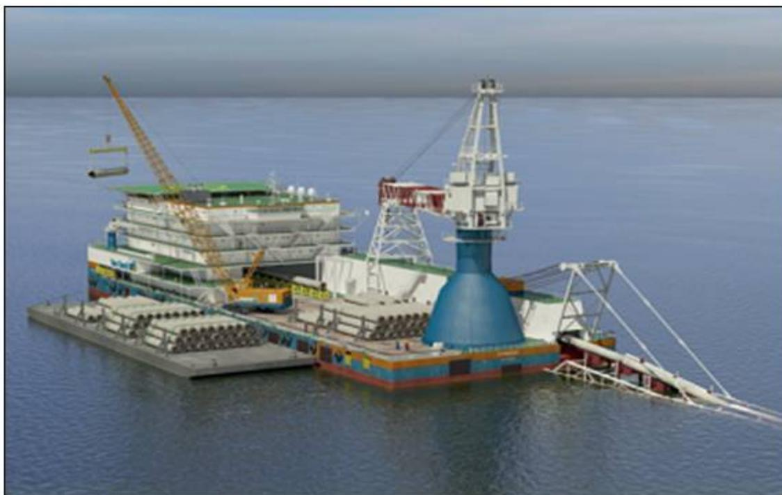
**Figura 7.c: Esempio di Nave Posatubi in Azione**
