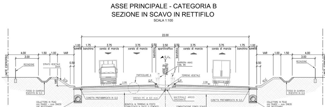
Figura - Sezione tipo in trincea dell'asse principale
