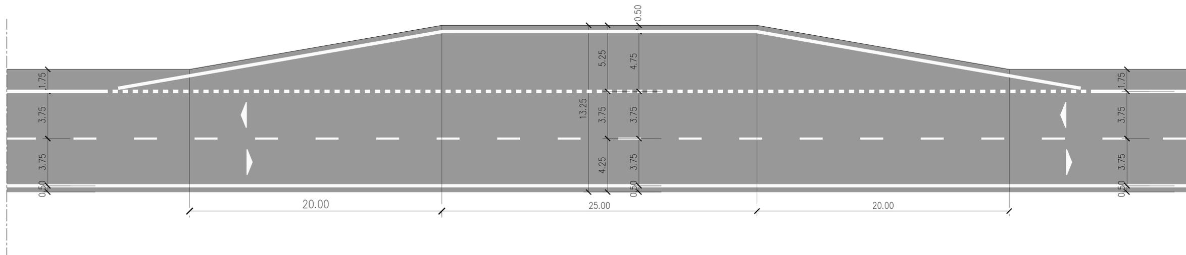
SEZIONE IN RILEVATO IN RETTIFILO CON PIAZZOLA DI SOSTA
