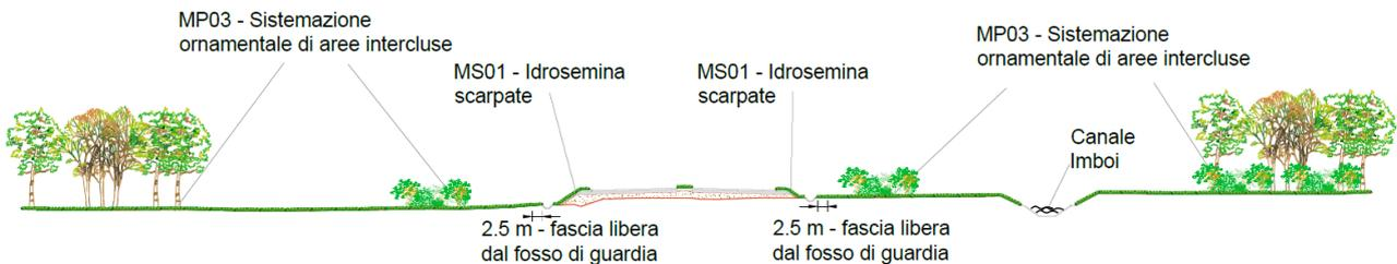
Figura 3.13: Esempio di applicazione dei tipologici delle opere a verde – sezione alla prog. 7+525
