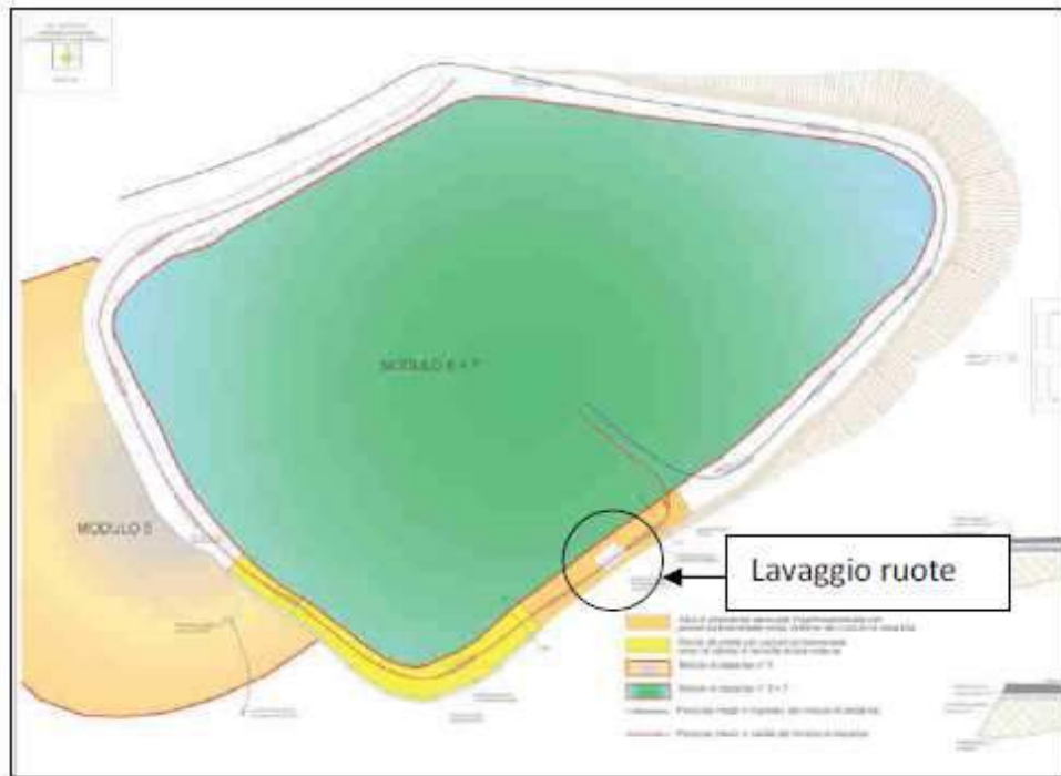
Fig. 10 Ubicazione impianto lavaggio previsto in progetto
