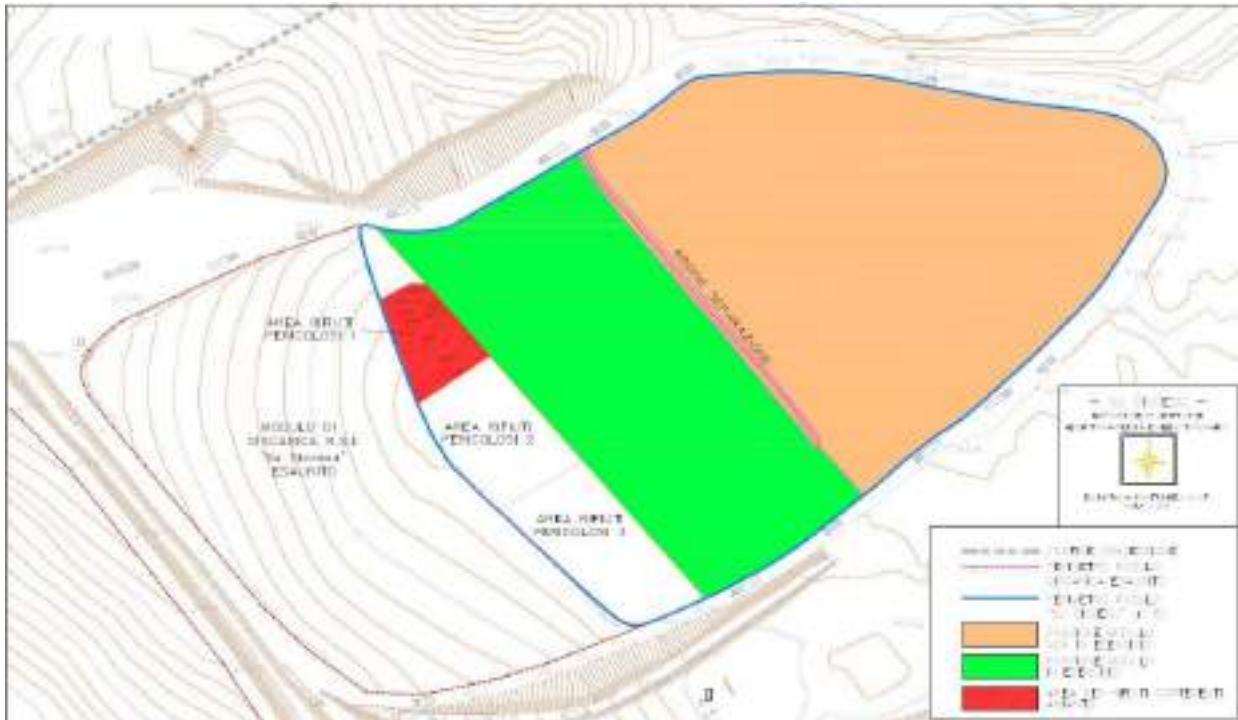
FIG. 4 : CELLE ADIBITE ALLO SMALTIMENTO DEI RIFIUTI PERICOLOSI E RIFIUTI CONTENENTI AMIANTO
