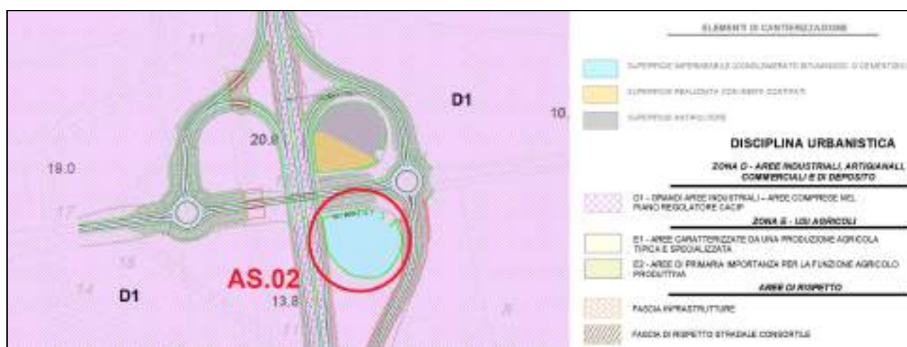
Figura 8-5 Sovrapposizione del tracciato e delle aree di cantiere operativo-stoccaggio sulla perimetrazione urbanistica – Area di stoccaggio AS.02.
