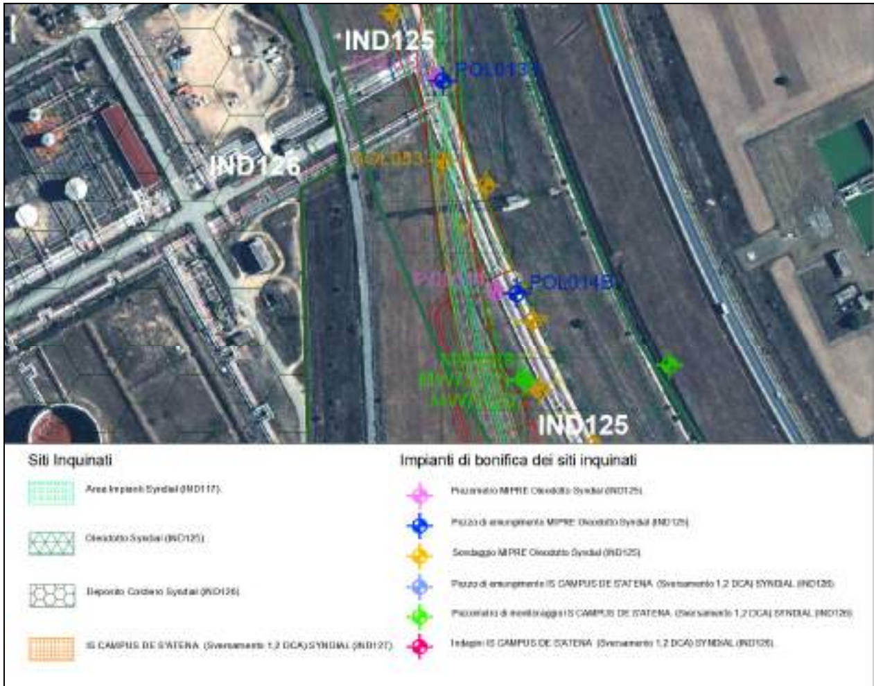
Figura 4-6 Sovrapposizione del tracciato e dei poligoni delle aree IND126 e IND125 su immagine satellitare, con indicati i pozzi ed i piezometri interferenti col tracciato. In particolare: POL013 e POL013B (progressiva 8+395), SOL053 (pk 8+350) e MW75 (pk 8+620).
