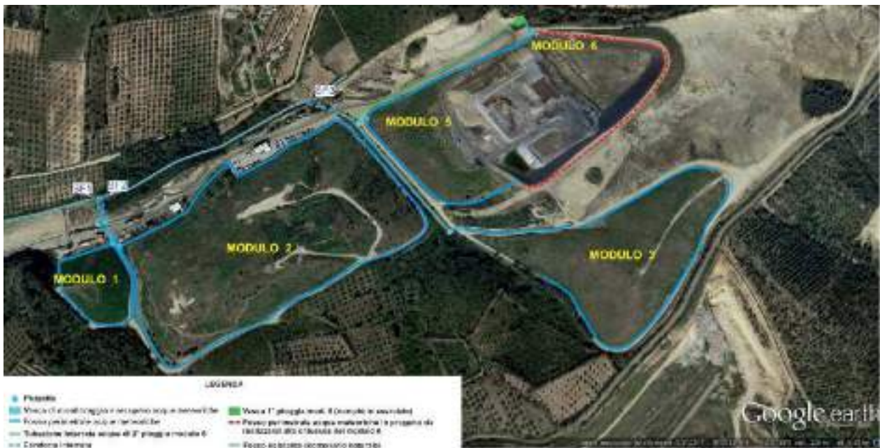
Fig. 7: Regimazione acque meteoriche di ruscellamento
