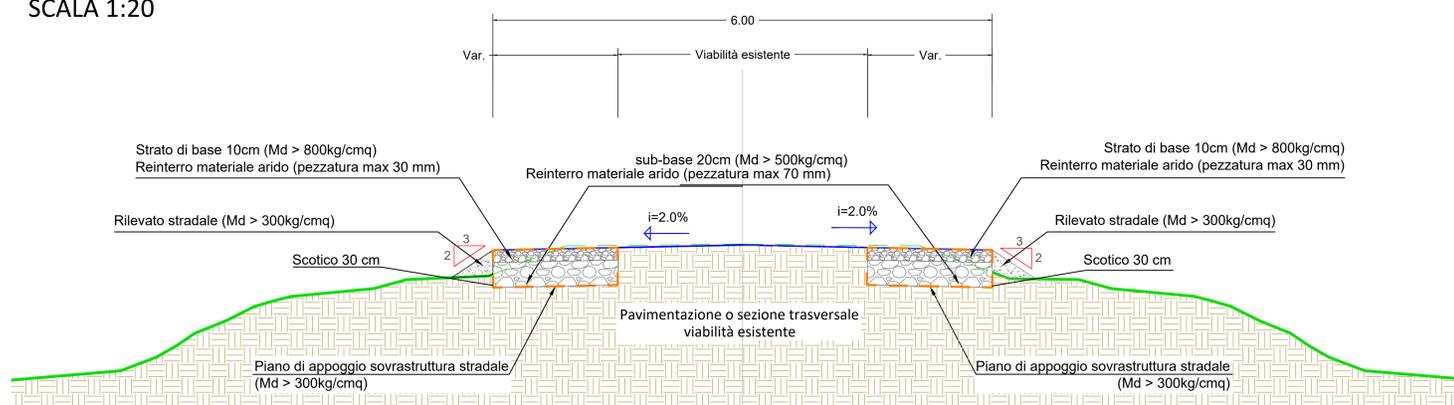
SEZIONE TIPICA VIABILITÀ DA REALIZZARE IN SCAVO
