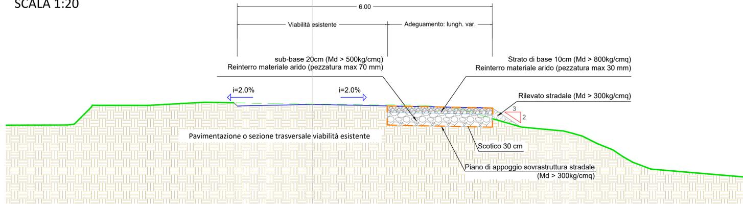
SEZIONE TIPICA VIABILITÀ DA REALIZZARE IN RILEVATO
