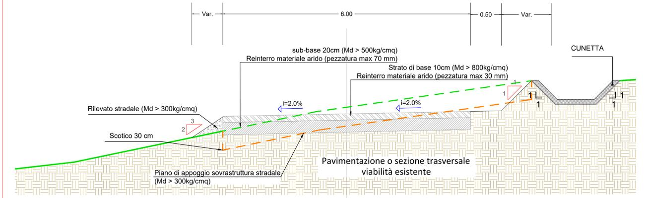
SEZIONE TIPICA VIABILITÀ ESISTENTE CON ADEGUAMENTO SUL LATO DESTRO
