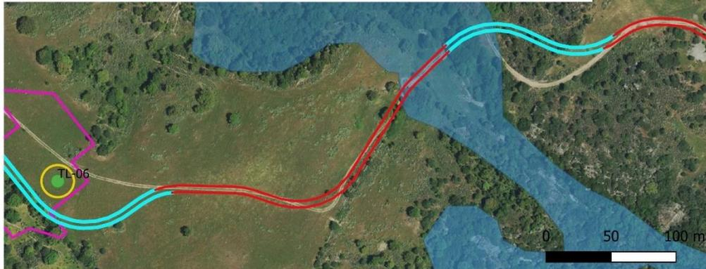
**Figura 4.3: Sovrapposizione delle opere in progetto con aree a pericolosità idraulica Hi4 cartografate dal PUC di Telti in adeguamento al PAI**
