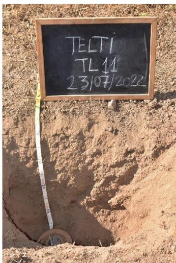
Il sito in cui è prevista l'installazione dell'aerogeneratore TL11 ricade su un substrato geologicamente composto da granitoidi paleozoici, morfologicamente inserito, su nella parte mediana di un versante collinare, a quota 326m s.l.m. L'unità cartografica di appartenenza come tutte le stazioni descritte nei precedenti paragrafi è la PLU e la pendenza rilevata è di circa il 16%.
