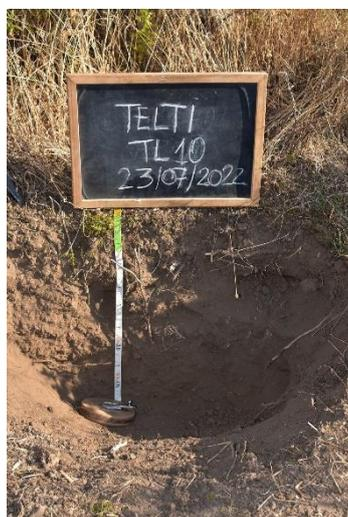
L'area in cui è prevista l'installazione dell'aerogeneratore TL10 ricade geologicamente sulle Facies Rio sa Raina formati da leucograniti a grana fine. Morfologicamente è posto sulla parte mediana di un versante collinare a quota 334m s.l.m., contraddistinto da una micromorfologia concava. L'unità cartografica di appartenenza è la PLU e la pendenza rilevata è di circa il 12%.
