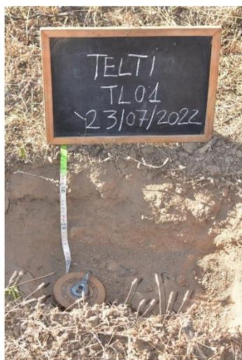
Il sito in cui è prevista l'installazione dell'aerogeneratore TL01 ricade su un substrato geologicamente composto dai granitoidi paleozoici. La morfologia del sito è subpianeggiante posto a quota di 360m s.l.m., contraddistinto da una micromorfologia concava. L'unità cartografica di appartenenza è la PLU e la pendenza rilevata è di circa il 5%.
