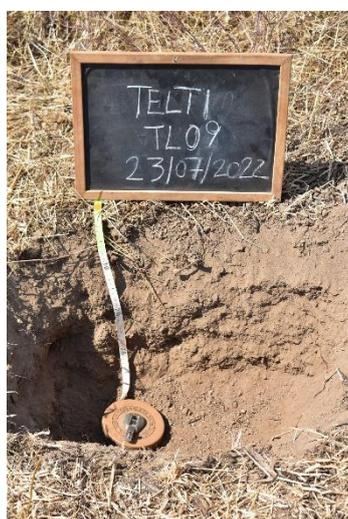
Il contesto morfologico, pedologico e di uso suolo del sito in cui è prevista la messa in posa dell'aerogeneratore TL09 è molto simile a quello già descritto in precedenza in quanto la turbina è ubicata in continuità con l'aerogeneratore TL08, a quota 390m s.l.m. L'unità cartografica di appartenenza è sempre la PLU. La stazione è ubicata nella parte alta del versante collinare e la pendenza rilevata è di circa il 11%, con micromorfologia concava.
