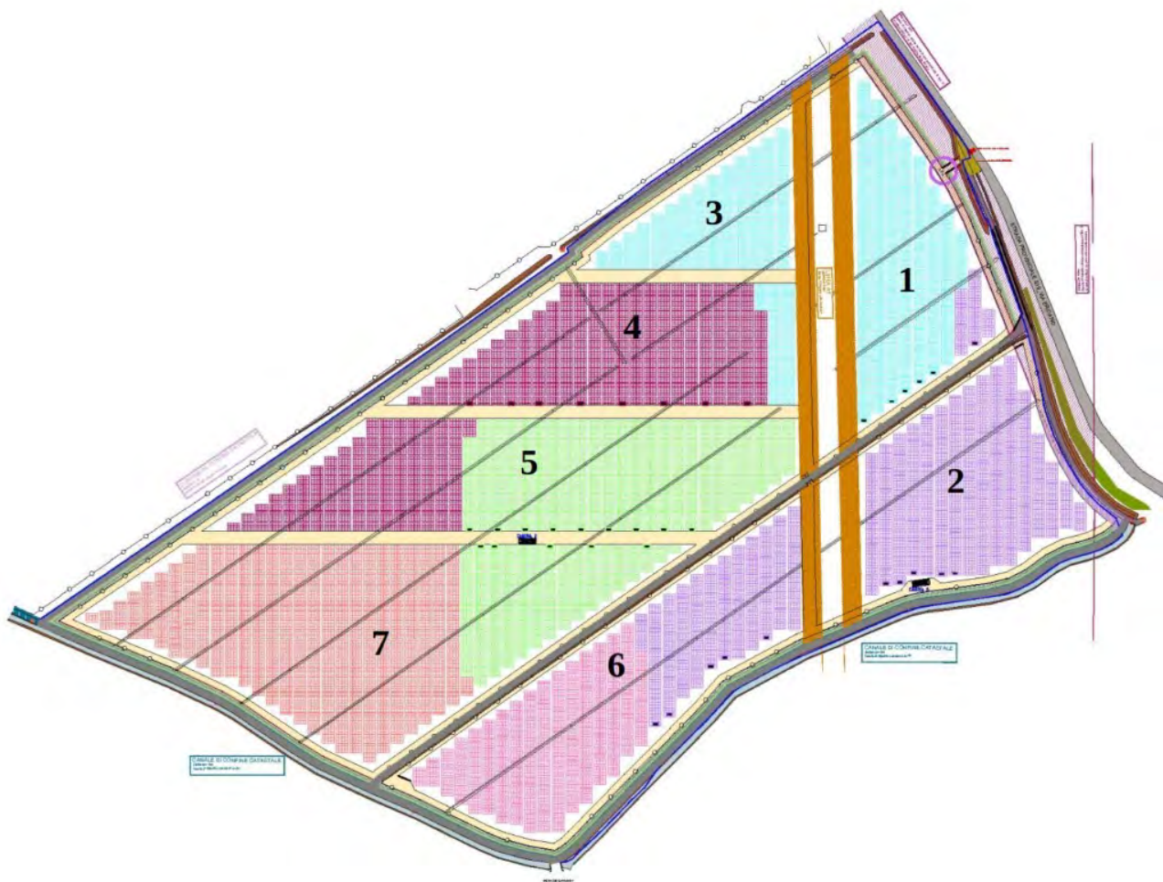
Figura 4: Suddivisione dell'area di progetto nei diversi sottocampi (indicati i sottocampi fisici, colorati i sottocampi elettrici)
