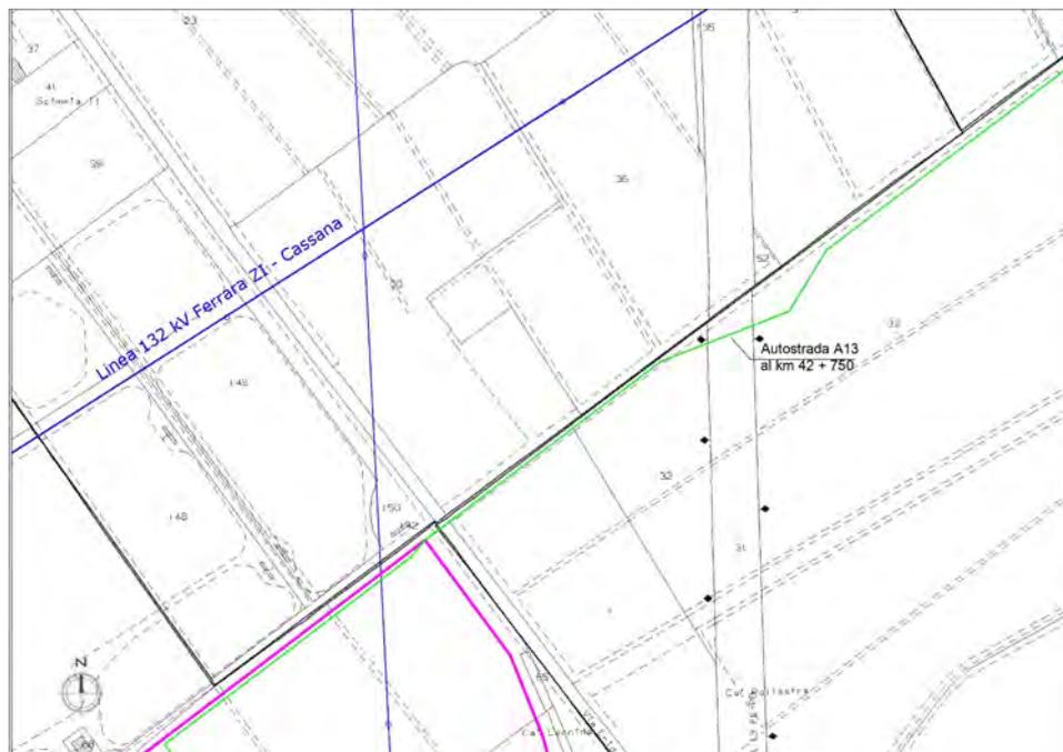
Figura 4: tracciato su base CTR dell'elettrodotto interrato da realizzarsi insieme all'impianto fotovoltaico per la connessione alla rete elettrica nazionale – 2° tratto
