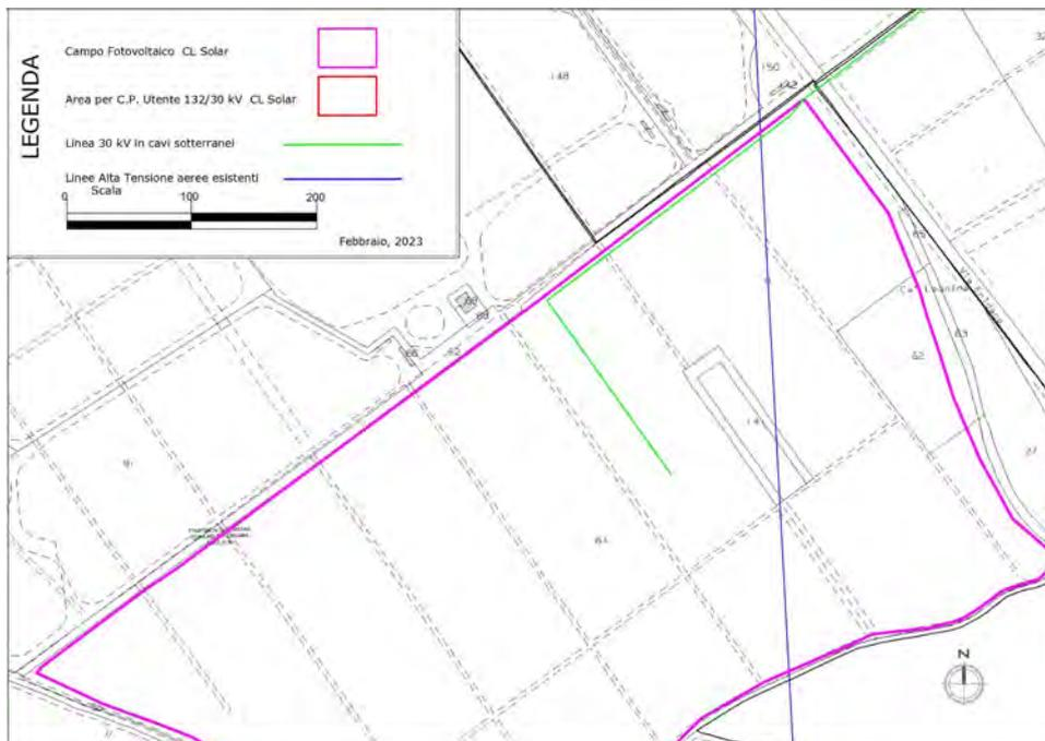
Figura 3: tracciato su base CTR dell'elettrodotto interrato da realizzarsi insieme all'impianto fotovoltaico per la connessione alla rete elettrica nazionale – 1° tratto
