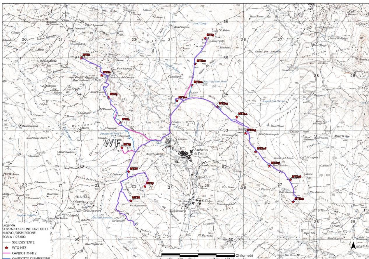
**Fig. 5 Tracciato elettrodotti impianto esistente (colore blu) e dell'impianto di progetto (colore magenta)**
