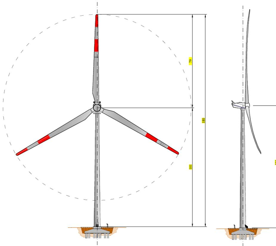
**Fig. 11. Caratteristiche dimensionali: Prospetto aerogeneratore GE 158 da 6,1 MW.**
