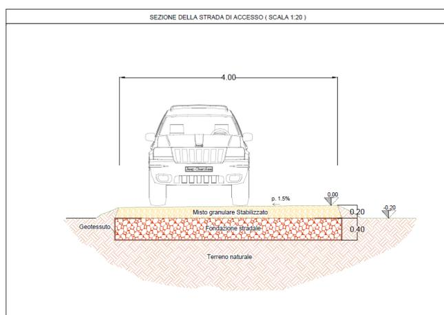
**Fig. 17** Schema della sezione stradale per nuova viabilità.
