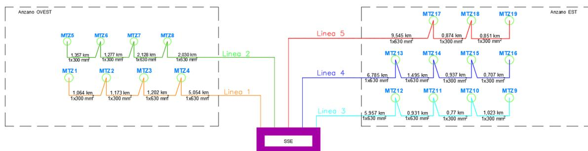
Fig. 15 Schema elettrico a deformata di collegamento degli aerogeneratori alla sottostazione
