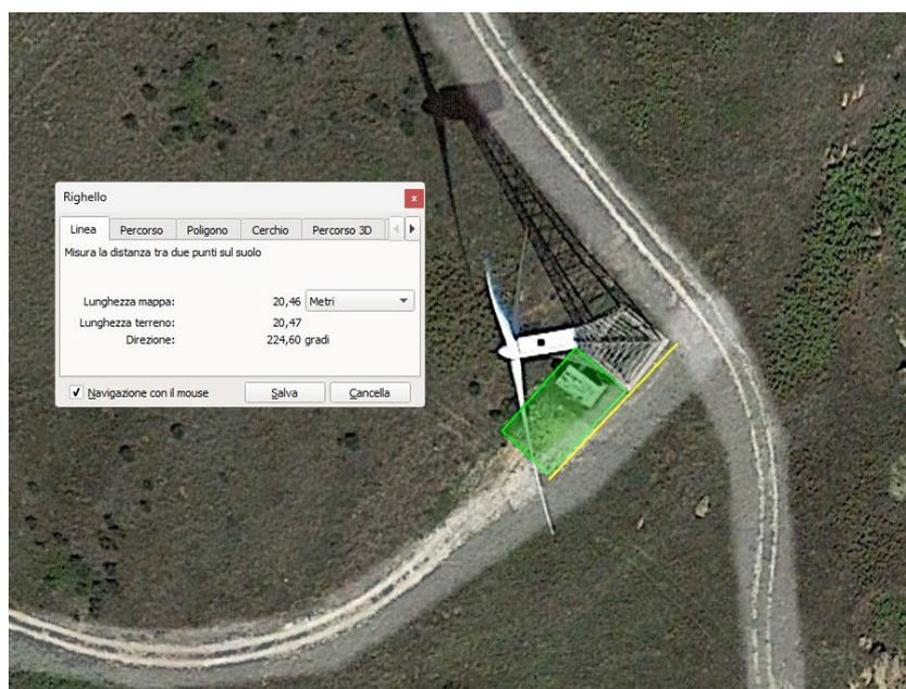
**Fig. 3 Esempio di piazzola di aerogeneratore esistente.**
