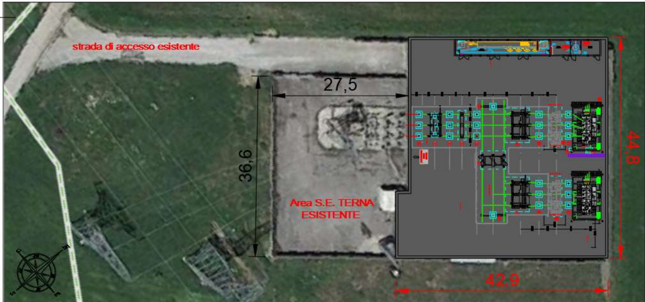
Fig. 3. Planimetria elettromeccanica della sottostazione
