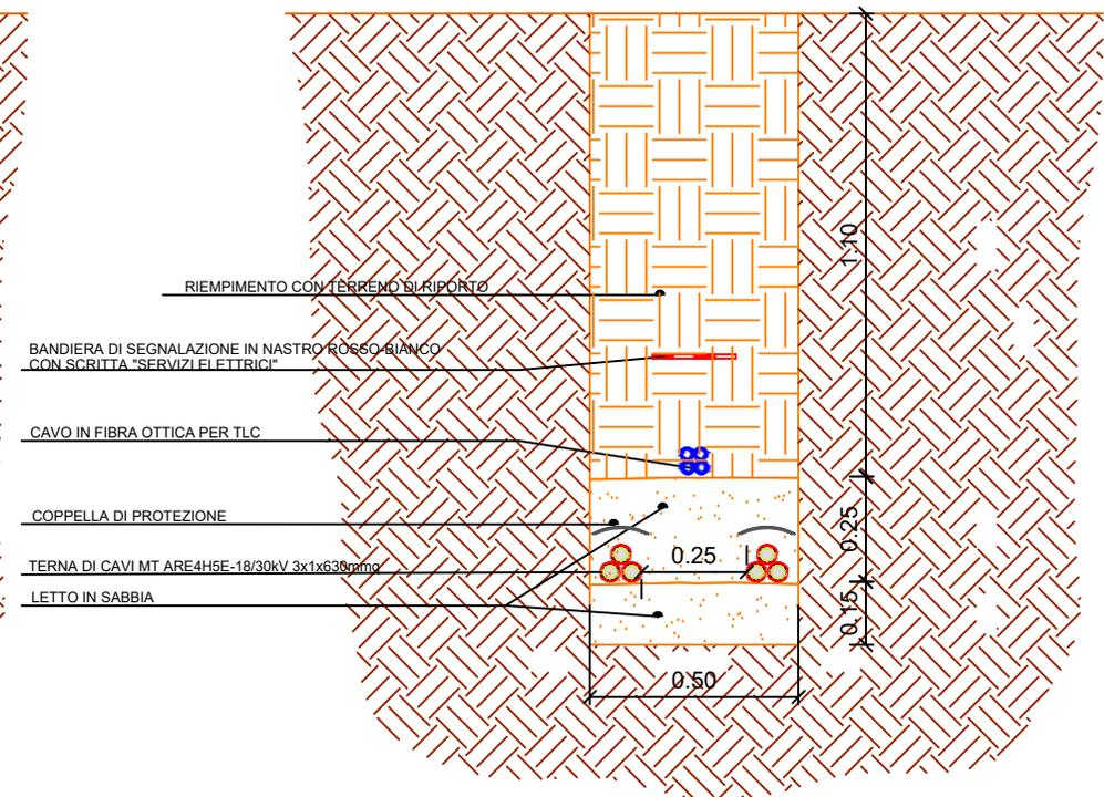
PARTICOLARI SEZIONI DI SCAVO A TRINCEA PER ELETTRODOTTI INTERRATI SU TERRENO E SU STRADA O PIAZZOLA ( SCALA 1:20)
