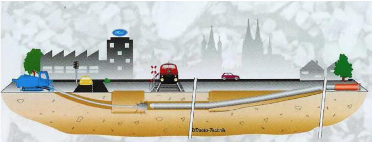
Figura 6.12. – Schema di principio dell'attraversamento in T.O.C.
