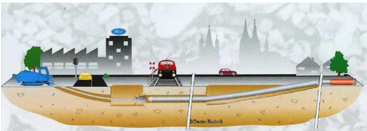
Figura 11. Schema di principio dell’attraversamento in T.O.C.
