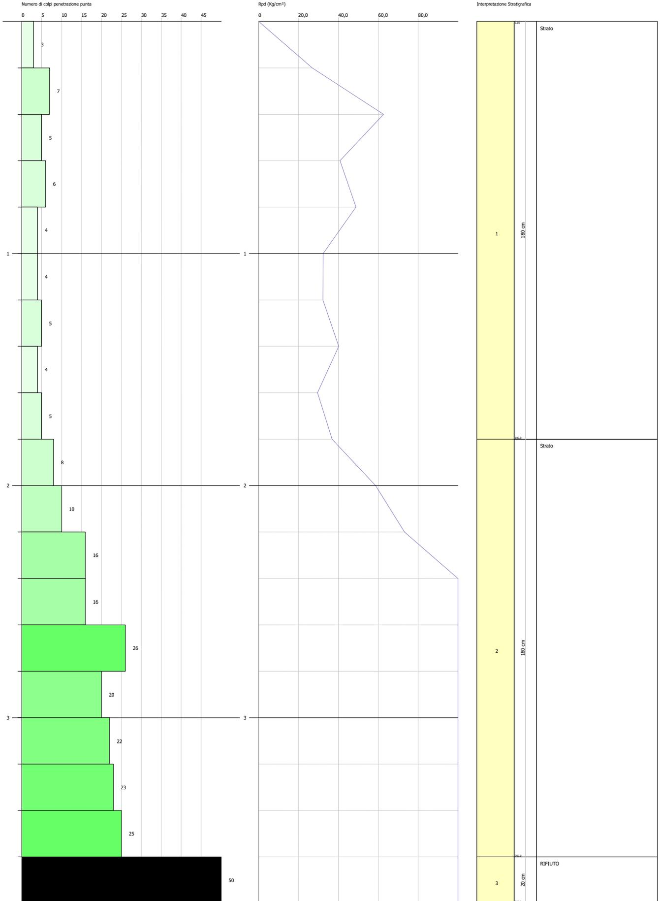
**PROVA PENETROMETRICA DINAMICA DPSH2**
