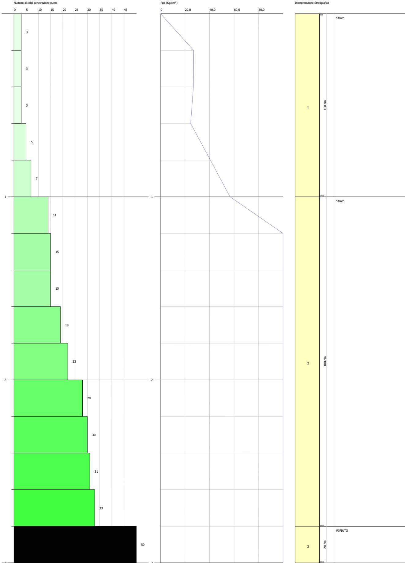
**PROVA PENETROMETRICA DINAMICA DPSH3**
