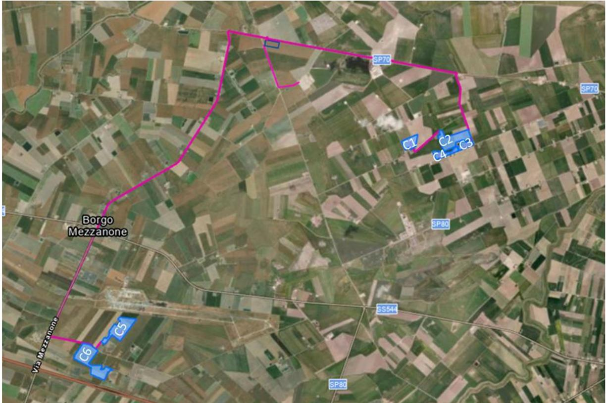
Figura 4.9: In MAGENTA il percorso di connessione dal campo FV alla SSE
