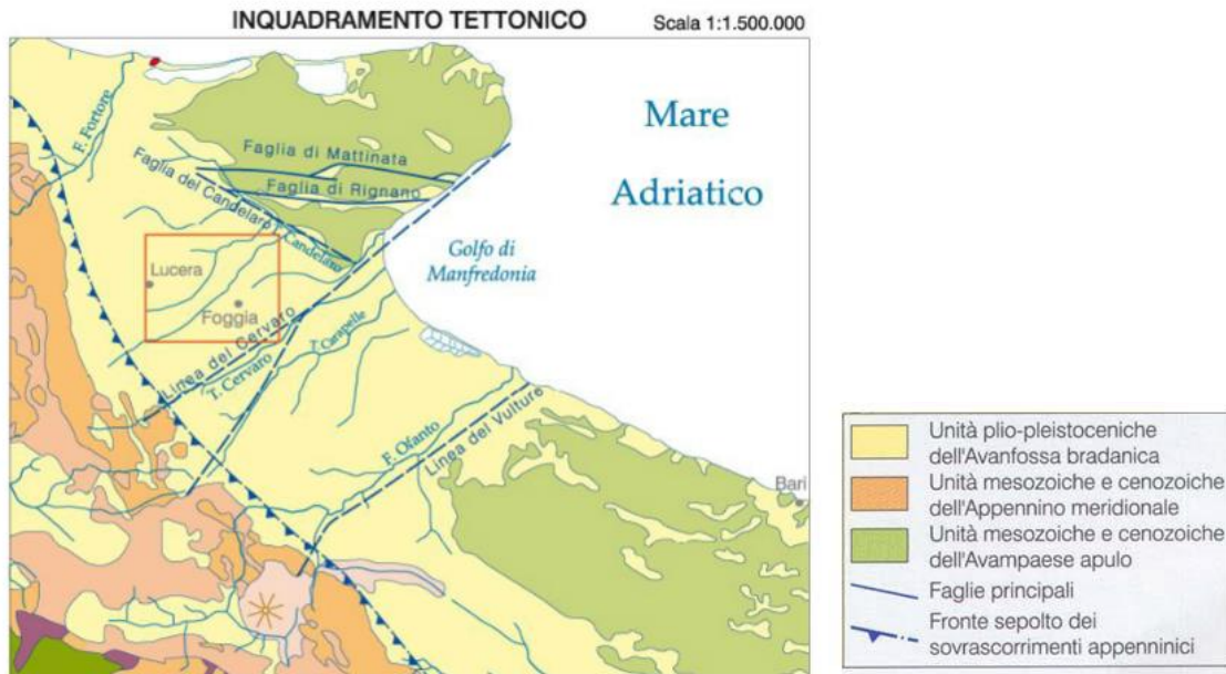
Figura 3.6: Schema geologico e strutturale dell'area del Tavoliere e del Subappennino Dauno.
