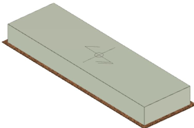
*Fig. Vista assonometrica fondazione per sezionatore tripolare orizzontale*
