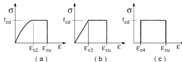
*Diagrammi di progetto tensione – deformazione del calcestruzzo.*
