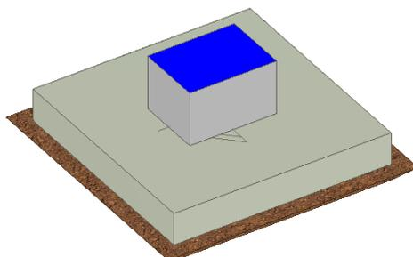
Fig. Vista assometrica fondazione per trasformatore di corrente
