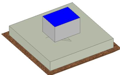
Fig. Vista assonometrica fondazione per terminale cavo AT
