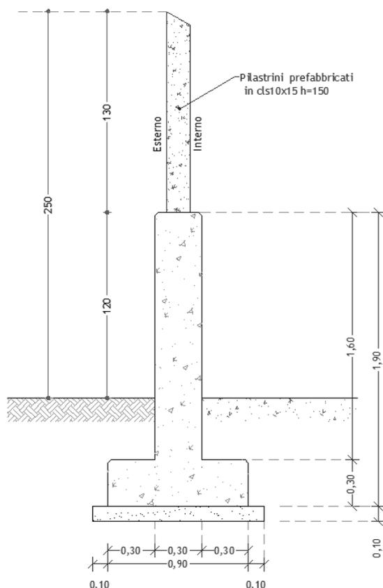
Fig. Sezione muro recinzione
