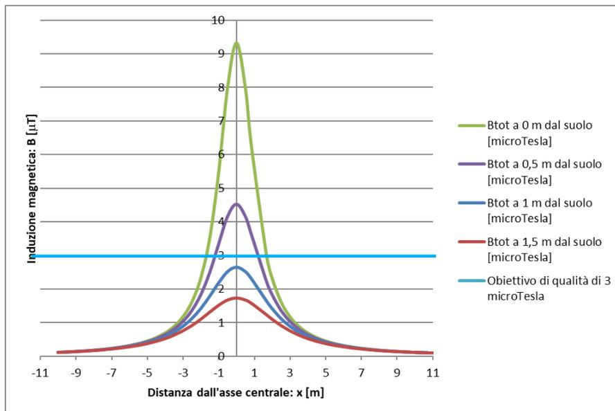
Figura 3: Andamento del campo magnetico generato dal cavidotto, composto da tre terne da 630 mm<sup>2</sup>
