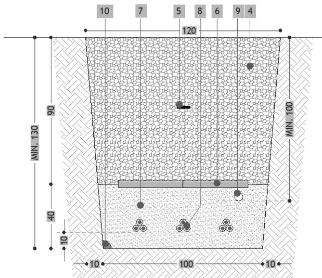
Figura 2: Sezione tipo cavidotto composta da tre terne da 630 mm<sup>2</sup>
