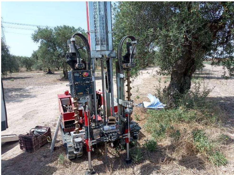
Prova penetrometrica dinamica pesante DPSH 01
