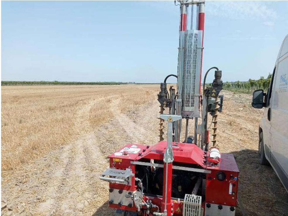
Prova penetrometrica dinamica pesante DPSH 02
