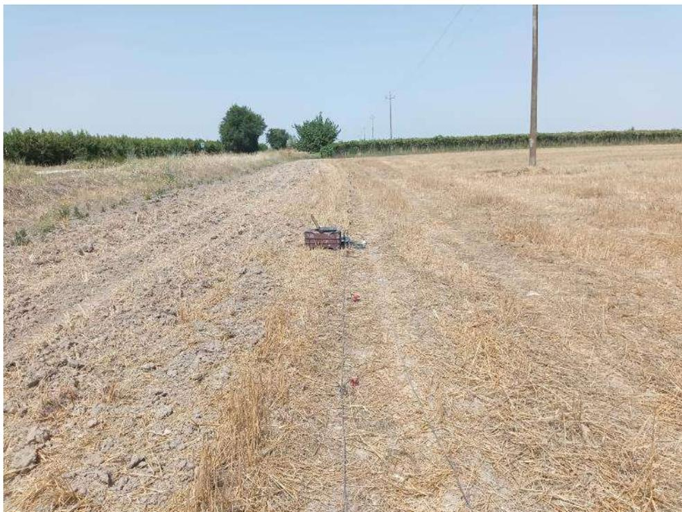
*Indagine sismica di superficie Masw M2*
