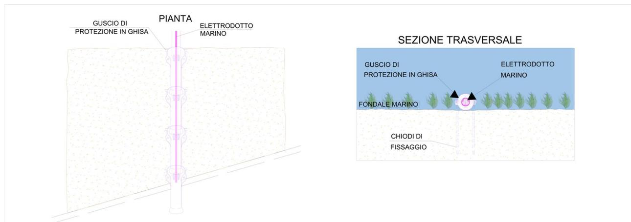
**Figura 3.14 – Tipico di posa dell'elettrodotto marino con protezione in elementi tubolari modulari.**
