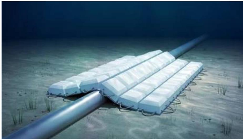
**Figura 3.12 – Esempio di posa con protezione a materassi in cls (rendering).**
