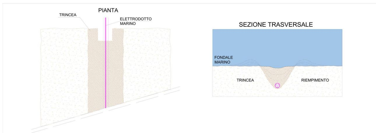
**Figura 3.4 – Tipico di posa dell'elettrodotto marino 66 kV AC.**
