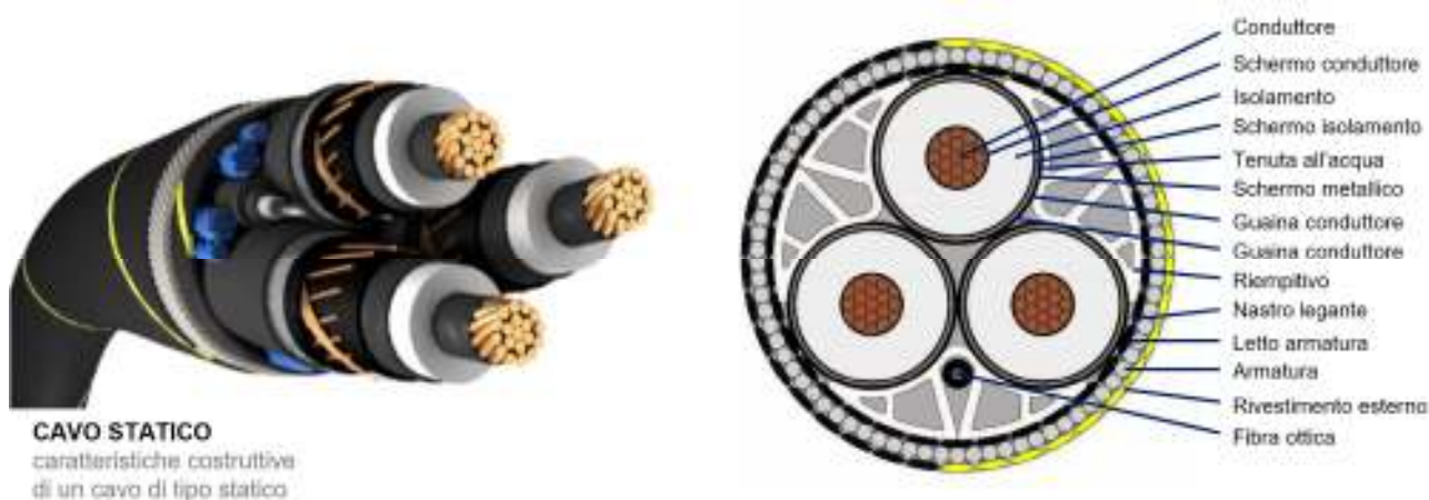
Figura 3.5 – Costruzione tipica di un cavo statico.
