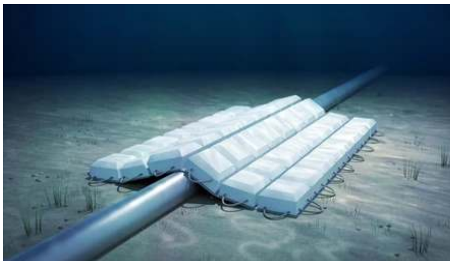
Figura 3.9 – Esempio di posa con protezione a materassi in cls (rendering).
