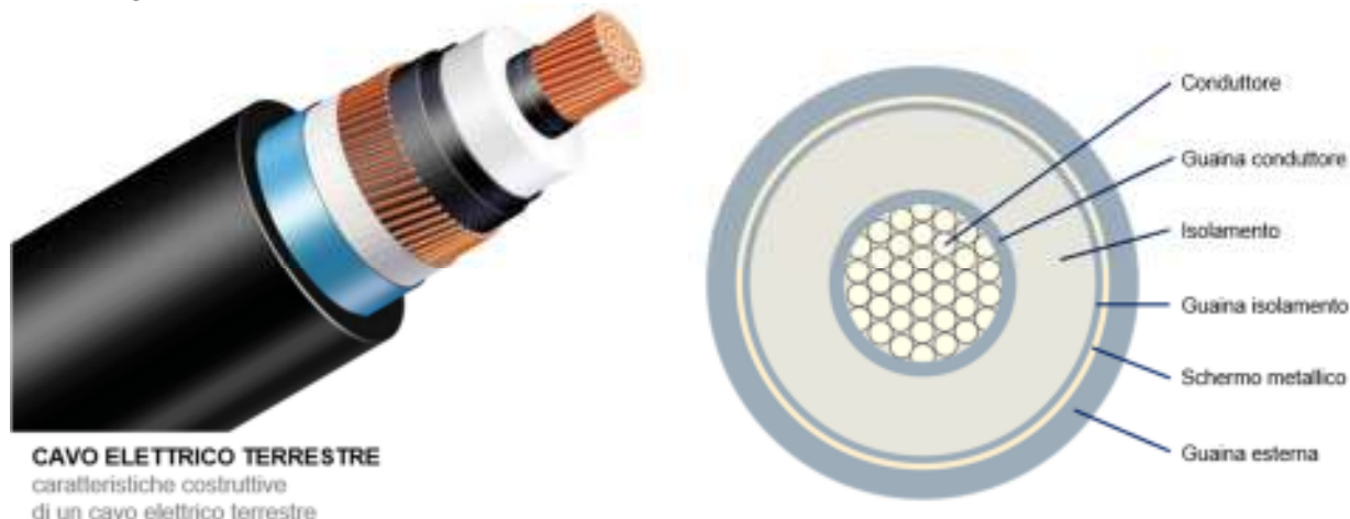
Figura 3.15 – Costruzione tipica di un cavo terrestre unipolare.
