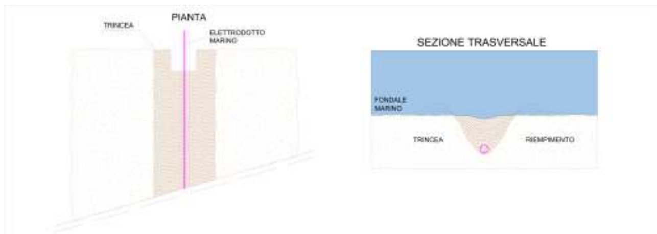
Figura 3.6 – Tipico di posa dell'elettrodo marino 66 kV AC.
