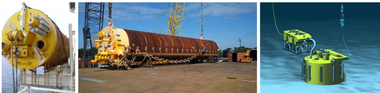
Figura 6.6 – Ancoraggio a suzione.
