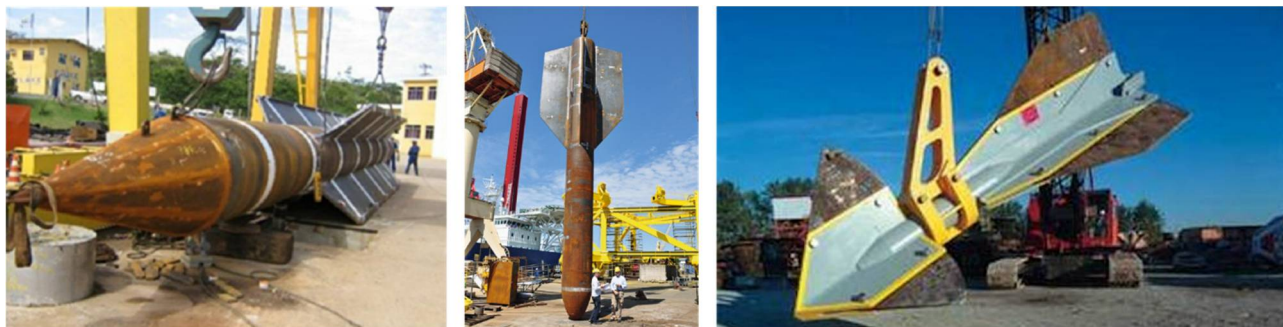
Figura 6.3 – Ancoraggio a gravità ad infissione dinamica.
