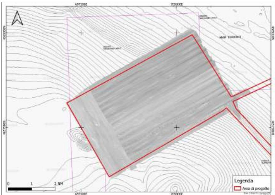
Figura 40. Il rilievo SSS dell'Area A (El. GIS ASPS da dati GBT Offshore)
