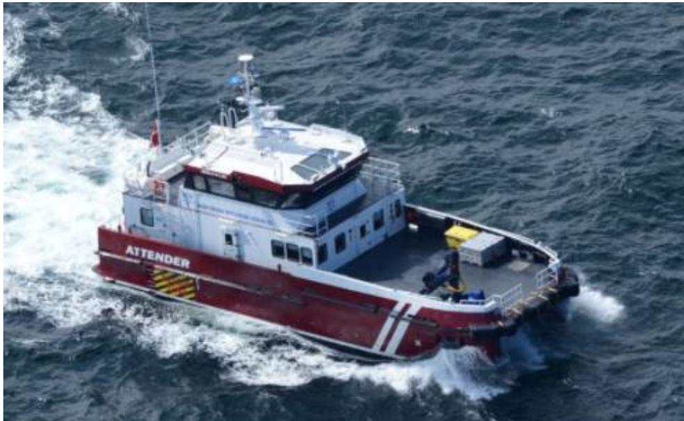
**Figura 5.1 – Esempio di imbarcazione CTV.**
