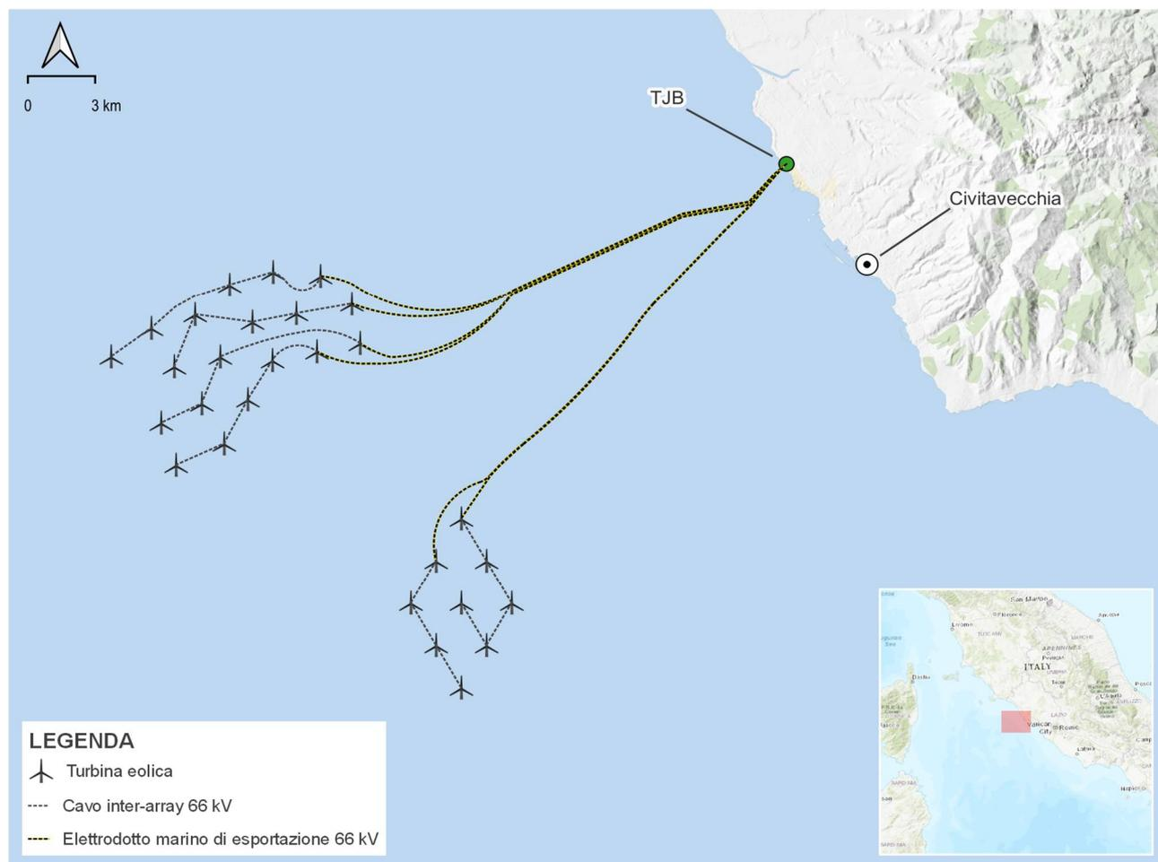
**Figura 3.3 – Disposizione dei cavi inter-array e dell'elettrodotto marino di esportazione.**
