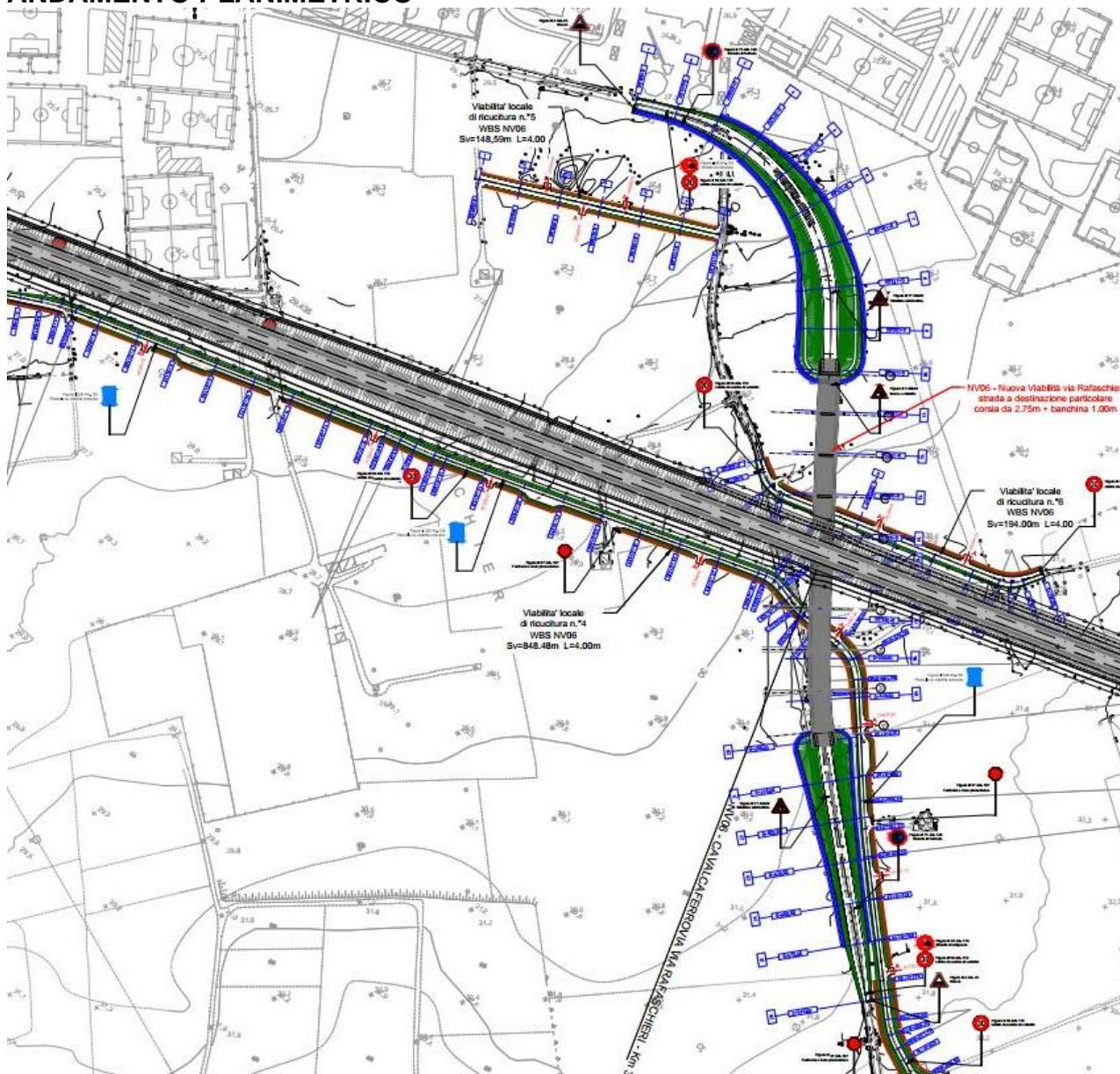
Per buona parte, le nuove strade interpoderali “di ricucitura” seguono l’andamento del piede del rilevato o della trincea della nuova linea ferroviaria e delle nuove strade di scavalco; l’andamento planimetrico della restante parte è dettato dalle effettive esigenze di rammaglio della viabilità locale e di riconnessione dei fondi. In particolare, l’andamento planimetrico delle viabilità di ricucitura 4, 5 e 6 è definito dalla successione degli elementi riportati nelle tabelle seguenti.
