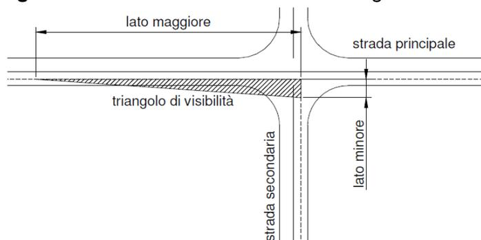
Nel caso di regolazione con STOP, un veicolo collocato a una distanza di 3 m dalla linea di arresto (posta lungo la linea di margine della carreggiata) deve poter avvistare un veicolo che percorre la strada principale, quando quest'ultimo si trova a una distanza  $D$ , definita:  $D = t \cdot v$  ove:
